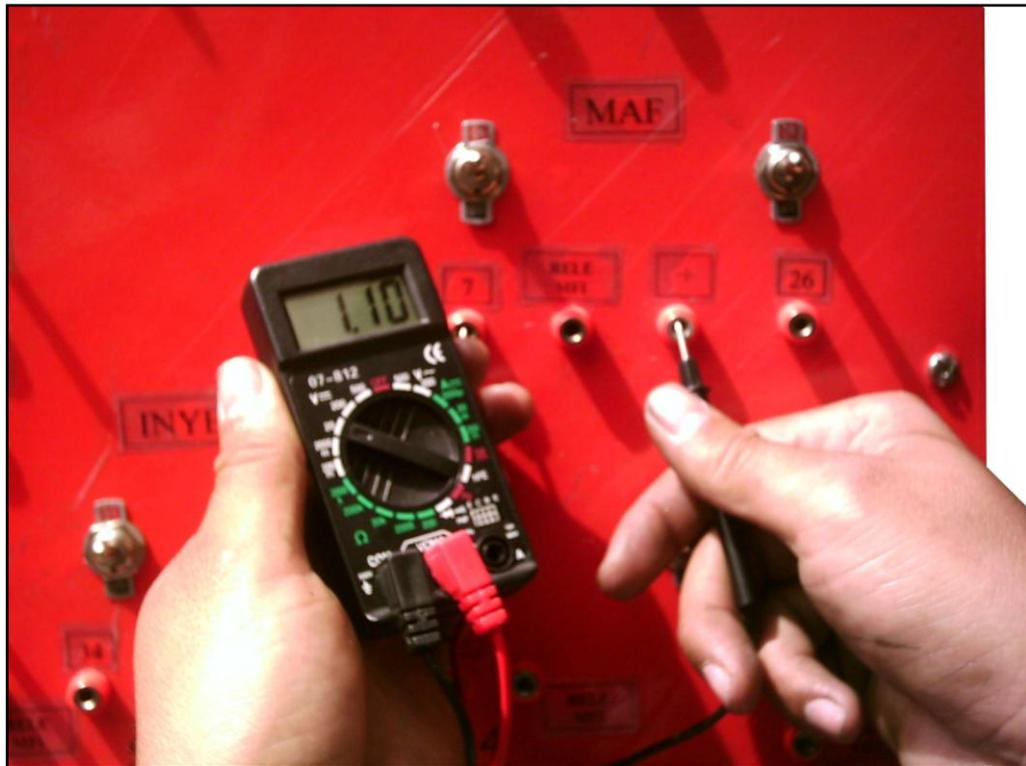
Figura 4.34 Voltaje entre los pines 7 y tierra
