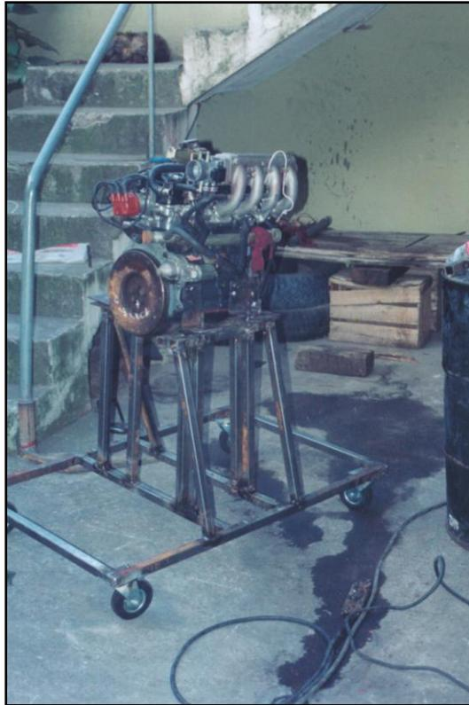
Figura 4.9 Bases para el motor terminadas
