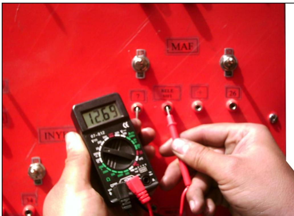
Figura 4.35 Voltaje entre los pines 7 y relé MFI
