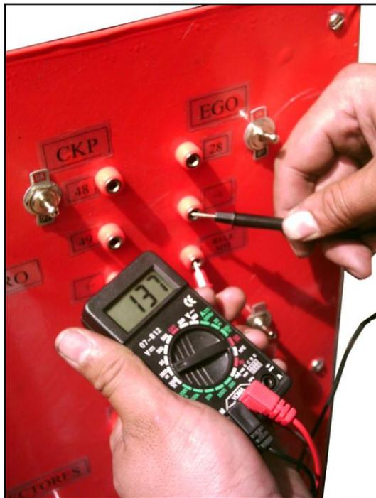
Figura 4.28 Voltaje entre los pines tierra y relé MFI
