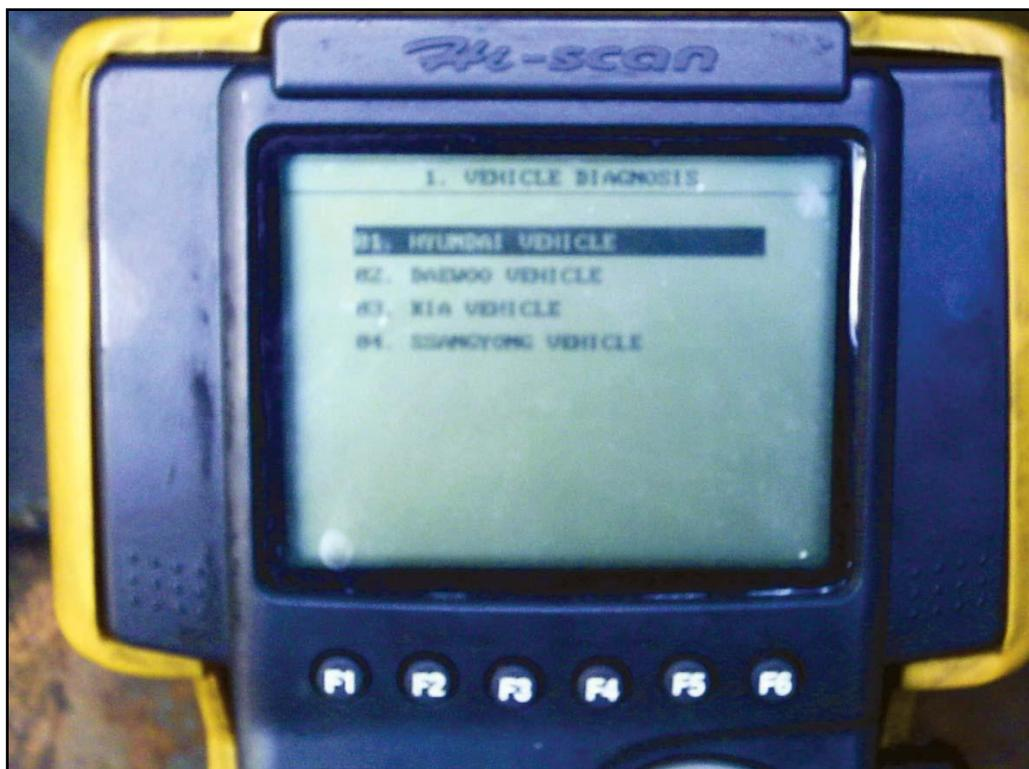
Figura 2.74 Pantalla para seleccionar la marca del vehículo
