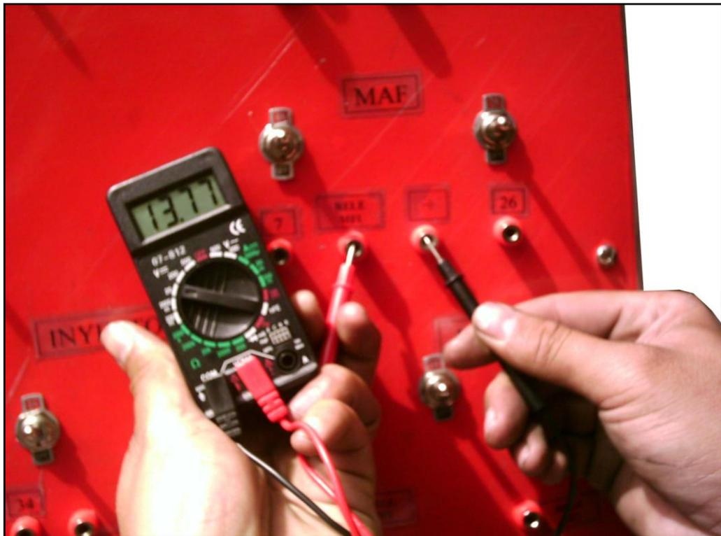
Figura 4.36 Voltaje entre los pines relé MFI y tierra
