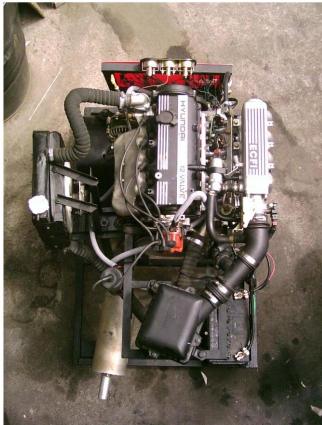
Figura 4.12 Vista superior del banco de pruebas terminado
