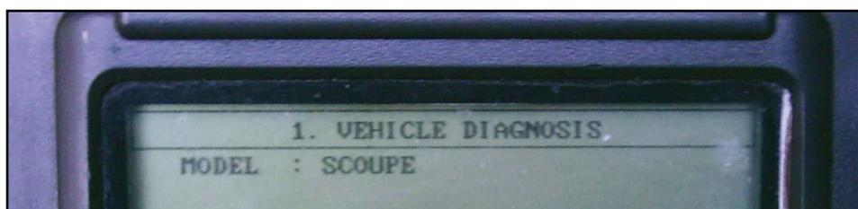
Figura 2.76 Pantalla para seleccionar el tipo del motor
