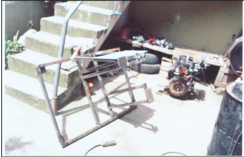
Figura 4.7 Bases para el motor
