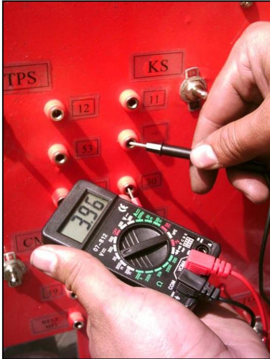
Figura 4.24 Voltaje entre los pines tierra y 30
