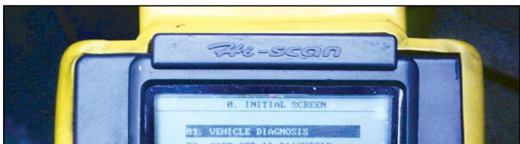
Figura 2.74 Pantalla para seleccionar las diferentes funciones del escáner
