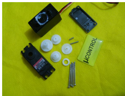
Figura.1.27. Quitando los engranajes del servomotor.
