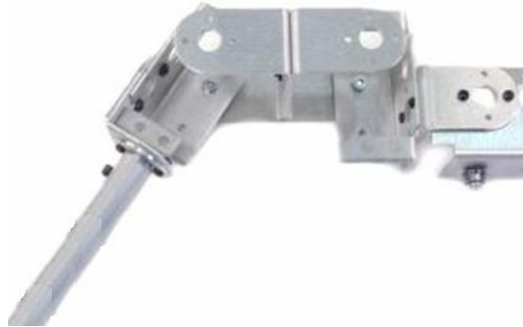
Fig. 2.33. Unión de todas las bases de los servomotores del robot hexápodo.
