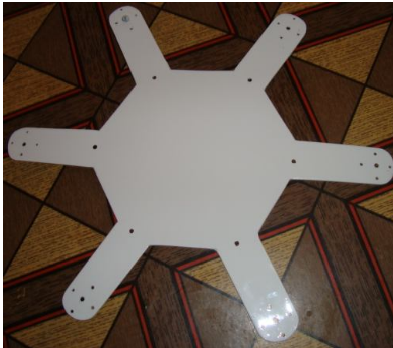
Fig. 2.9. Cuerpo real del robot hexápodo.
