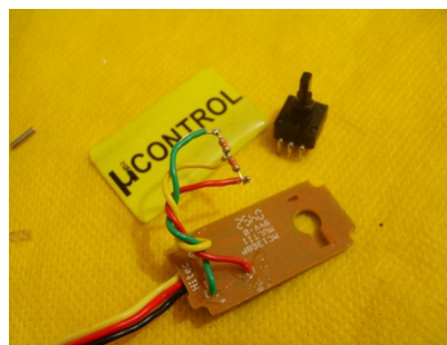
Figura.1.32. Cambiando resistencias por el potenciómetro.
