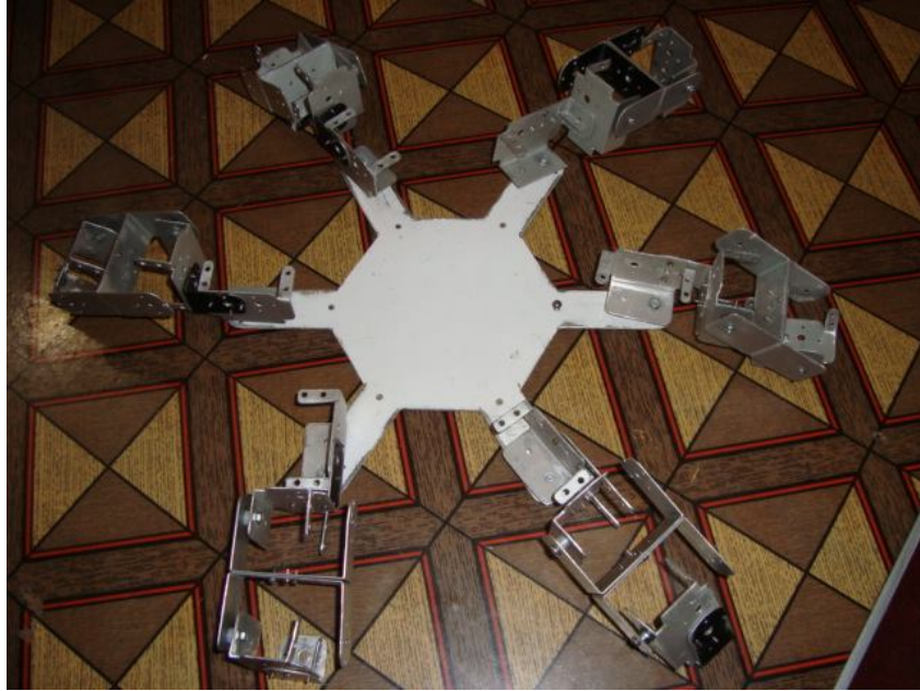
Fig. 2.34. Primera placa hexagonal acoplada a las bases los servomotores.
