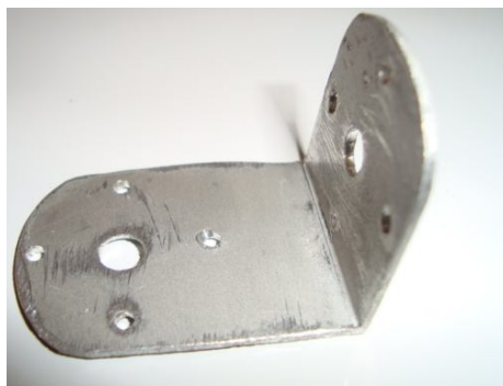
Fig. 2.5. Fragmento real tipo L, para unión de bases del servomotor.
