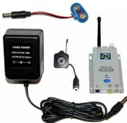
Fig. 2.28 Módulo de Transmisión y Recepción.
