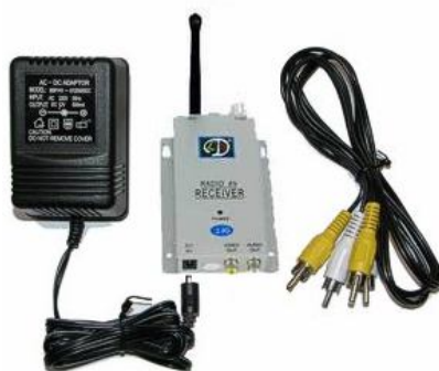
Fig.2.29. Módulo Receptor con cables de audio y video.
