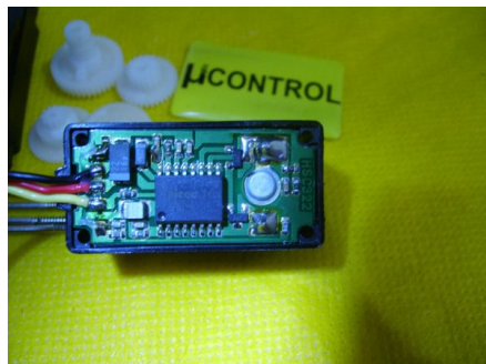
Figura.1.28. Placa electrónica del servomotor Hitec.
