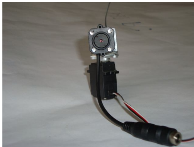
Fig. 2.41. Video cámara acoplada al servomotor.
