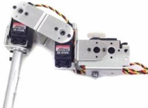
Fig. 2.1. Pata del robot hexápodo.
