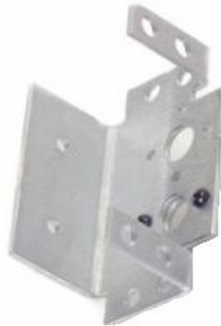
Fig. 2.3. Fragmento real de la base del servomotor del robot hexápodo.
