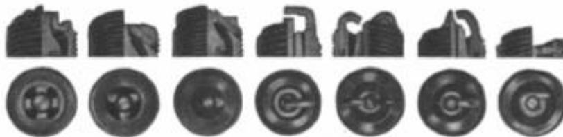
Fig. 1.15 Tipos de electrodos de masa.
