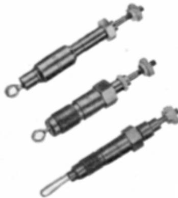
Fig. 1.27 Bujías de incandescencia.
