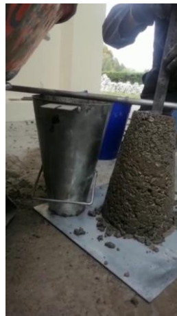
Cono de Abrams en prueba de asentamiento
