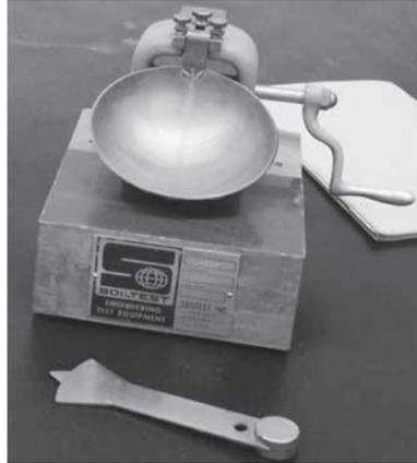
*Nota.* En la figura representa un esquema de copa de Casagrande. Tomado del libro Fundamentos de Ingeniería por (Das, 2013).
