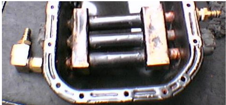
Figura 3.11 Intercambiador de tubos interiores vista superior
