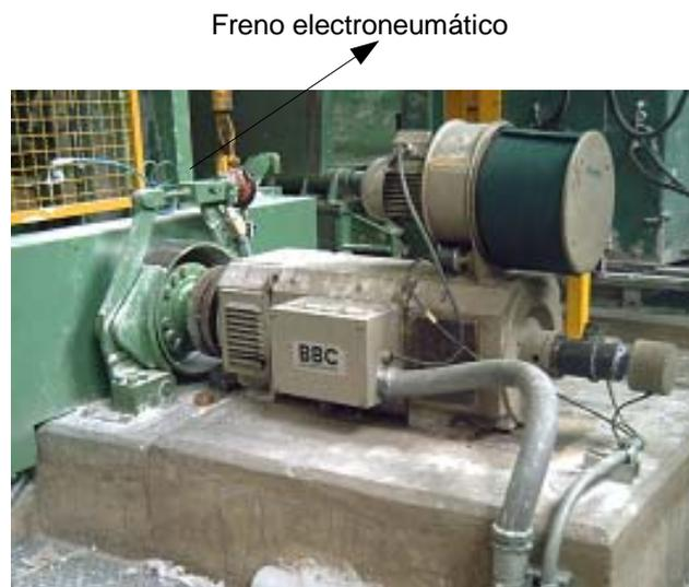
**Figura 3.11 Freno electro neumático**
