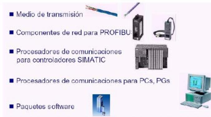
**Figura 1.29 Componentes PROFIBUS**
