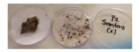
*Nota:* en la figura se muestra el material flotante y los microplásticos encontrados en un punto muestreado adicionalmente se muestra un macroplásticos perteneciente al mismo punto.
