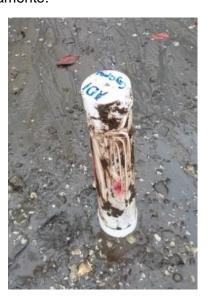
*Nota:* La figura muestra el tubo de PVC con la muestra recolectada y sellado herméticamente para transportarse al laboratorio. (Autoras, 2022).
