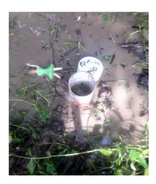
Nota: La figura muestra la toma de muestra de suelo con el tubo de PVC en las áreas determinadas. (Autoras, 2022).
