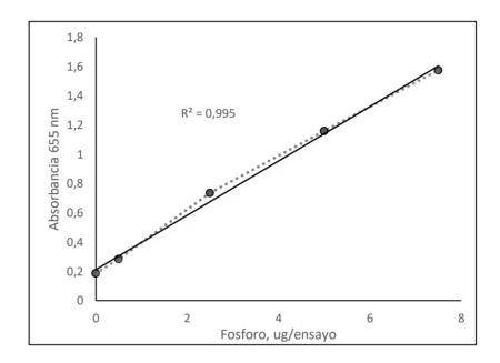
Nota. La curva de calibración demuestra la linealidad de la determinación colorimétrica de fósforo como se describe en el procedimiento K-PHYT. Los estándares de fósforo fueron analizados con 1 cm de trayectoria de luz.
