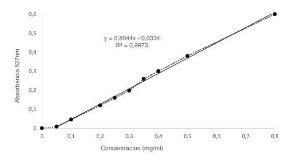
Nota. La figura representa la curva de calibración de ácido oleanólico, la curva cumple con la ley de Beer y posee una tendencia lineal, la absorbancia está directamente relacionada con la concentración, siendo el ajuste lineal positivo de  $R^2$  de 0,9947
