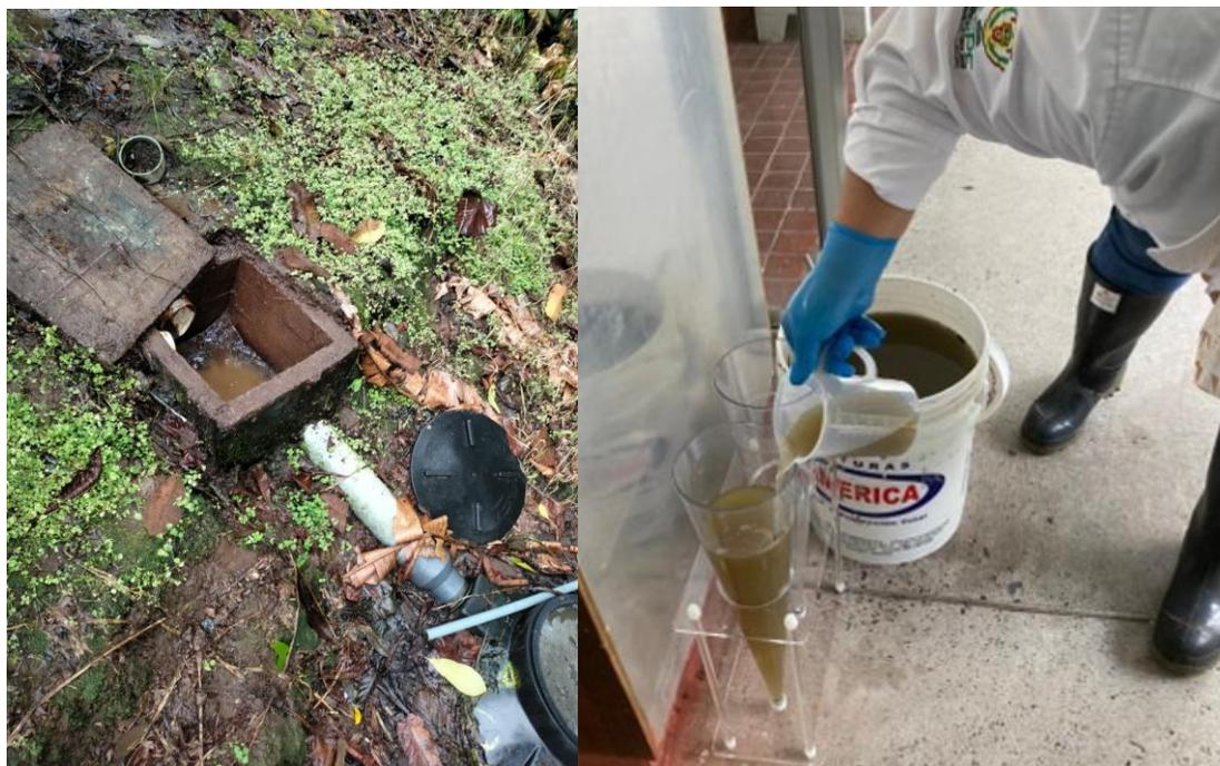
*Nota.* La figura representa el lugar de toma de muestra del agua y la sedimentación en tubo Imhoff.
