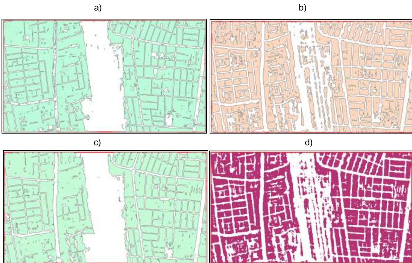
*Nota.* a) Generalización de datos con Modelo UNet y Backbone Model Resnet 34 con 200 épocas en los polígonos de manzanas, b) Generalización de datos con Modelo BDCN y Backbone Model Resnet 34 con 200 épocas en los polígonos de manzanas, c) Generalización de datos con Modelo UNet y Backbone Model Resnet 152 con 200 épocas en los polígonos de manzanas d) Generalización de datos con Modelo BDCN y Backbone Model Resnet 152 con 200 épocas en los polígonos de manzanas.
