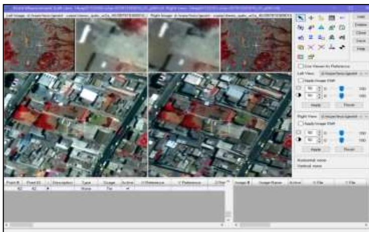
Se importan los puntos tanto para X, Y y Z, tomando en consideración que en las opciones para coordenadas en type debe estar "Full" y en usage "Control". Una vez importados, se procede a seleccionar la herramienta Compute image coordinates from the ground points (ver Figura 19), y automáticamente se dibujan los puntos, pero se necesita ajustar a la posición en que fueron tomados en campo, como se observa en la Figura 20.
