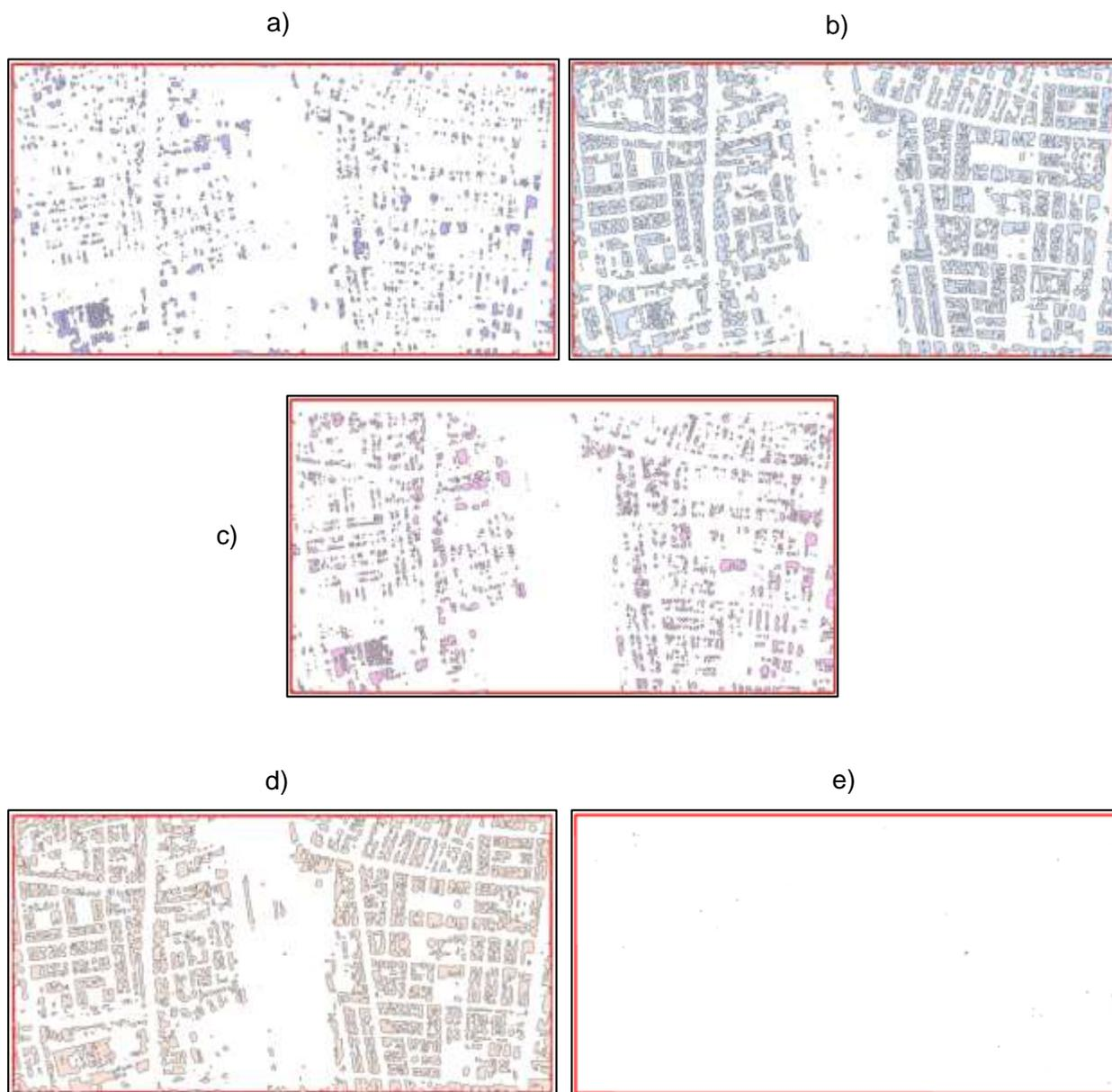
*Nota.* a) Generalización de datos con Modelo Unet y Backbone Model Resnet 34 con 100 épocas en los polígonos de edificaciones, b) Generalización de datos con Modelo BDCN y Backbone Model Resnet 34 con 200 épocas en los polígonos de edificaciones, c)
