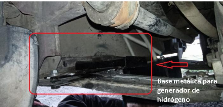
Base metálicas reactor
