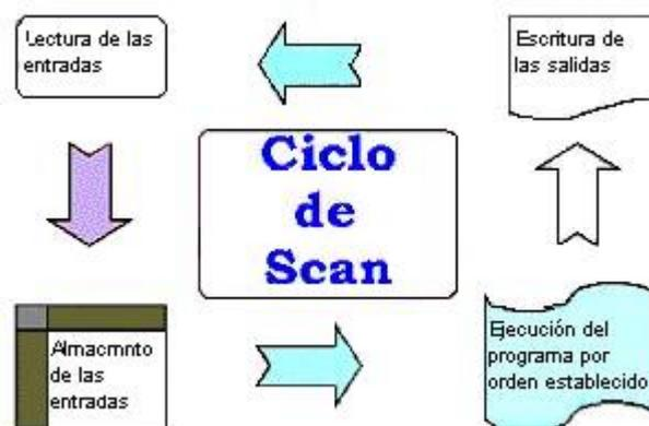
Figura 1.3 Ciclo de funcionamiento del PLC
