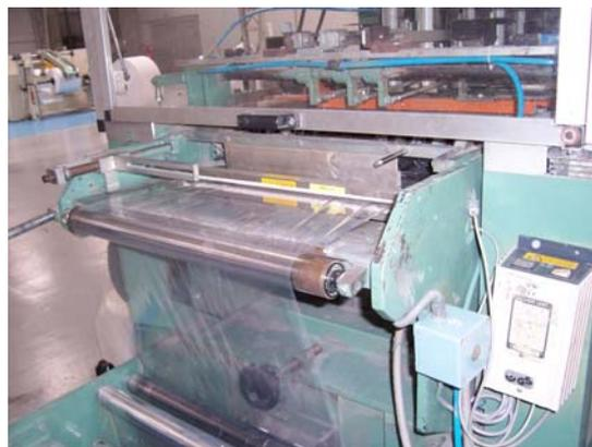
**Figura 3.13 Barra antiestática y freno del debobinador**
