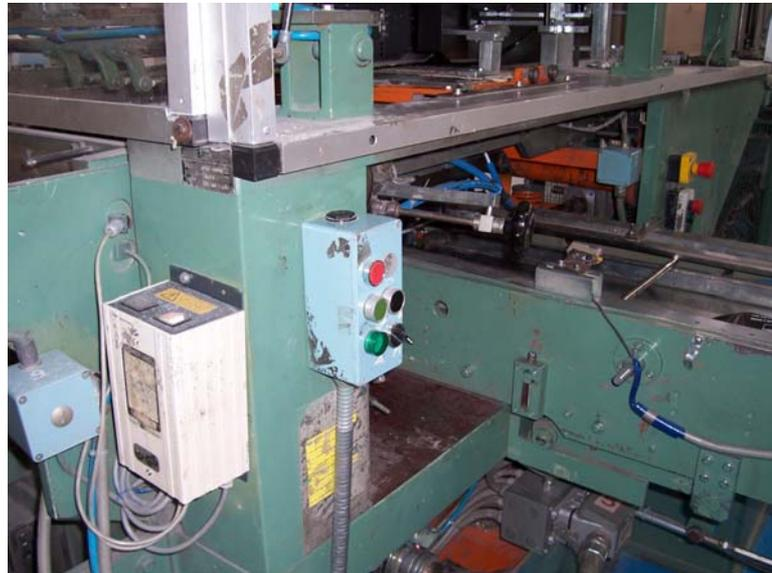
**Figura 3.5 Paneles de operador de la sección de empacado**
