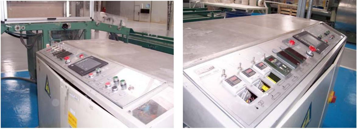
**Figura 3.4 Dispositivos de mando y control del panel frontal de la máquina**
