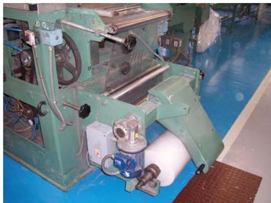
**Figura 3.12 Debobinador de polietileno**
