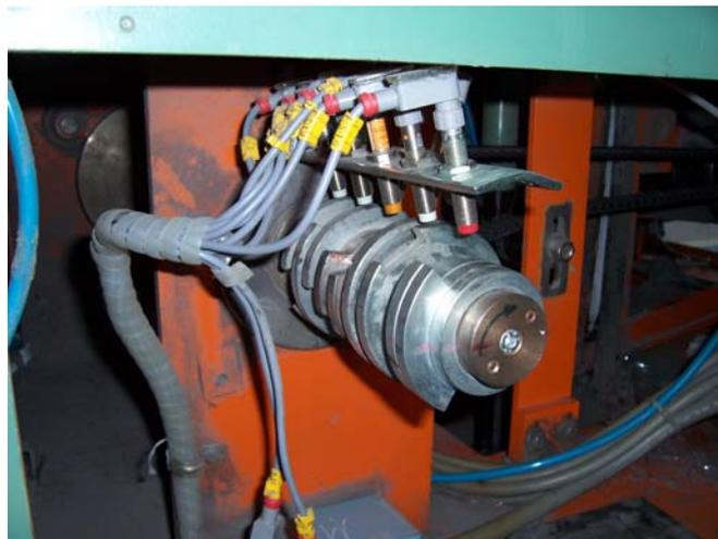
**Figura 3.15 Túnel de levas**
