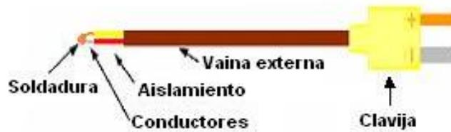
Figura 1.32 Aspecto físico de un termopar
