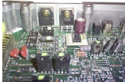
Figura 1.16 Transistores de potencia utilizado para controlar los actuadores del sistema EDC propuesto
