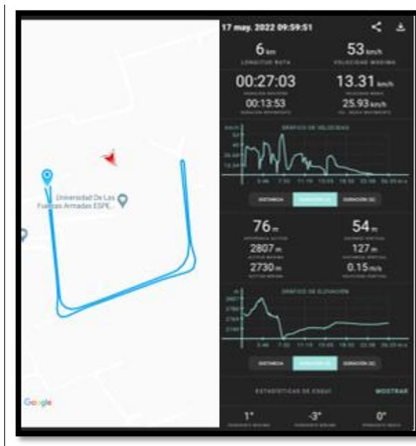
*Nota.* Se determina la longitud y velocidad a través de la ruta desarrollado con una velocidad variable.
