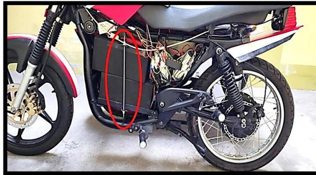
*Nota.* La varilla roscada señalada en color rojo se encuentra sosteniendo las baterías mediante tuercas de presión, brindando seguridad y firmeza.
