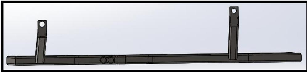
*Nota.* El modelado en 3D representas de tres bases para las uniones de la estructura del sidecar hacia la motocicleta.
