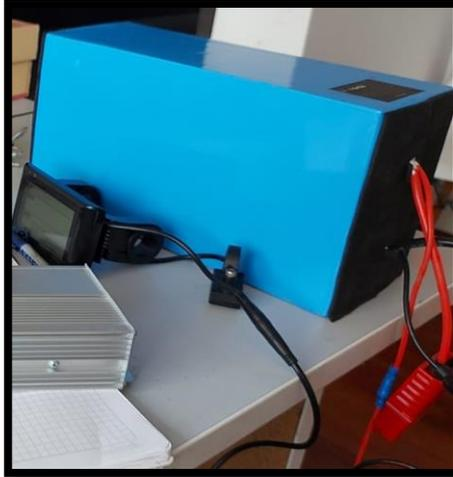
*Nota.* La figura representa una de las baterías de 48V a 32.2 A y sus respectivos conectores, ya que contiene una corriente elevada, deberá contener conductores de mayor calibre para una mayor fluidez de corriente.
