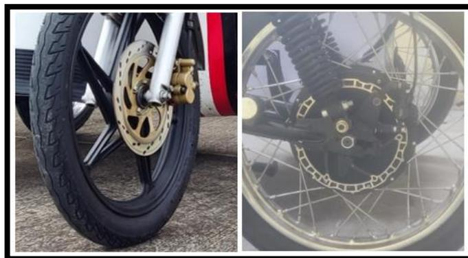
Nota. Instalación de los frenos de disco en la parte delantera y posterior de la motocicleta.
