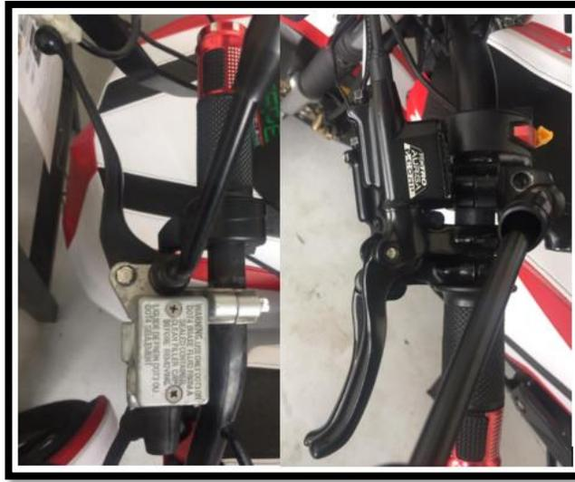
*Nota.* En la figura se exponen los comandos de los frenos electrohidráulicos instalados en el volante de la motocicleta.
