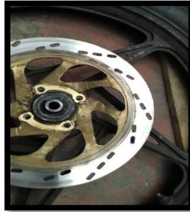
*Nota.* Se muestra el freno de disco delantero con configuración para hiperventilación con sus respectivas sujeciones en el aro permitiendo un frenado instantáneo.
