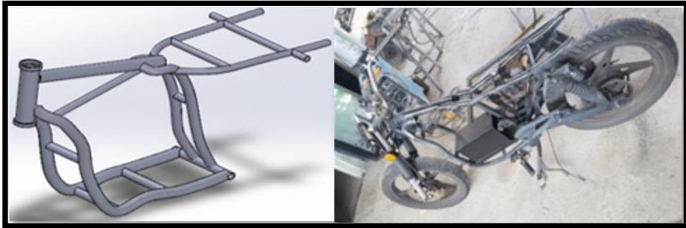
*Nota.* En la tubería estructural redonda se visualiza las modificaciones del bastidor de la motocicleta eléctrica para la adaptación de los sistemas eléctricos – electrónicos.
