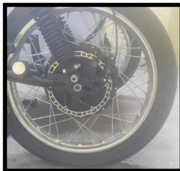
*Nota.* El freno de disco posterior se encuentra adaptado al motor eléctrico, conjuntamente con el freno eléctrico, ya que el mecanismo va a estar acoplado a la horquilla posterior.
