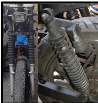
*Nota.* Se comprueba la instalación de los amortiguadores delanteros y posteriores que están sujetos a las horquillas y a los ejes de los aros.
