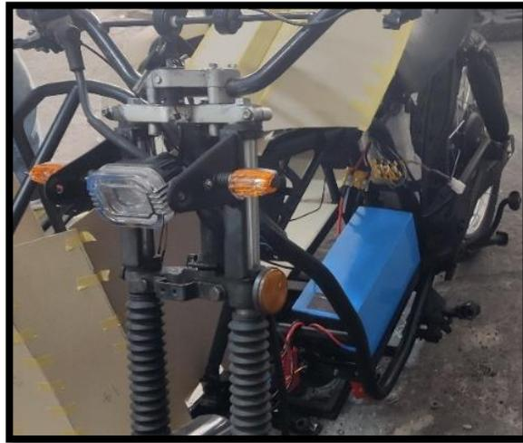
*Nota.* Se realiza la instalación de una batería en el bastidor de la motocicleta, verificando que las conexiones queden de forma segura y cómoda para la manipulación del operario.
