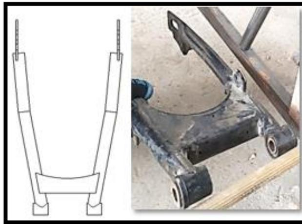
*Nota.* Del diseño de la estructura de la horquilla o basculante posterior, se adaptó para la sujeción al bastidor de la motocicleta y de los ejes de motores eléctricos.
