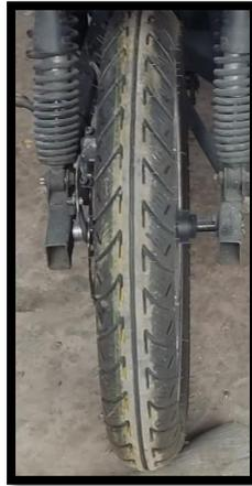
*Nota.* Instalación del neumático en el aro posterior, y en la horquilla basculante de la motocicleta.
