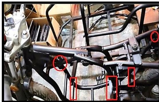
*Nota.* Los recuadros detallan los soportes para las baterías dando así una mayor estabilidad y los círculos muestran los soportes del convertidor y los controladores, que se encuentran en interacción con el bastidor de la motocicleta.
