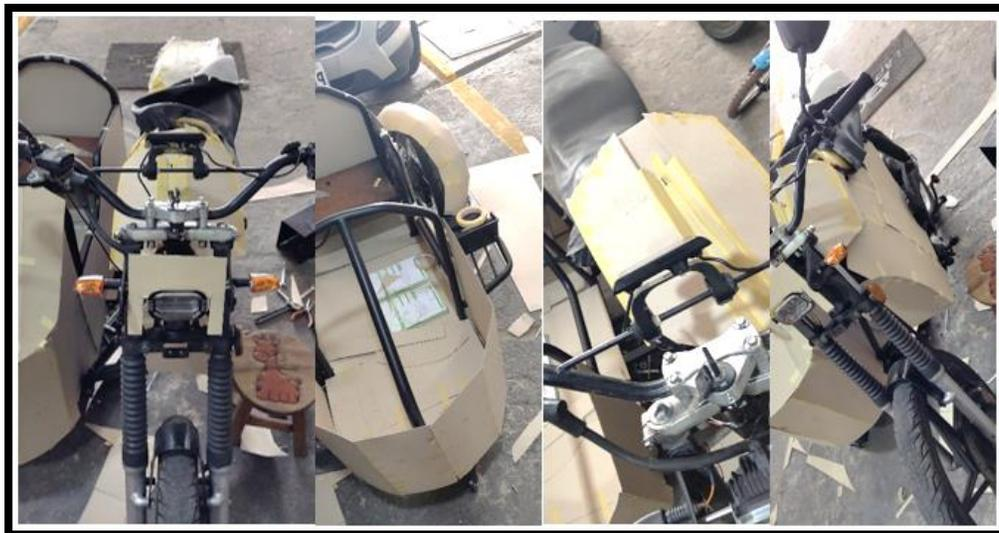
*Nota.* Se visualiza el uso del material reciclable para el moldeo de las diferentes fibras, considerando las medidas adecuadas para que no interfieran con la movilización de los componentes mecánicos, según el diseño de acuerdo a los bastidores de móvil eléctrico.
