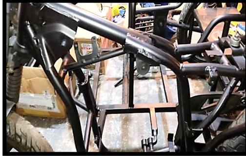
*Nota.* En la figura se visualiza la estructura donde se ubica las baterías, convertidores, y controladores en el bastidor de la motocicleta.
