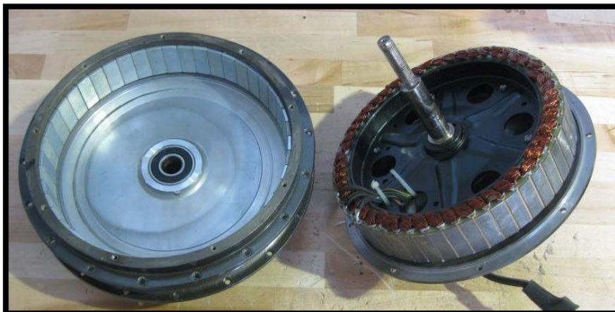
*Nota.* La figura representa los componentes que conforma el motor de corriente alterna empleado para motocicletas eléctricas. Tomado de Grin Technologies. (2017). *Direct drive hub motors* [Fotografía]. ebikes. <https://ebikes.ca/learn/hub-motors.html>.
