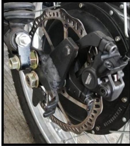
*Nota.* La adaptación del freno del disco a la carcasa del motor eléctrico, y la mordaza a la horquilla del sidecar.
