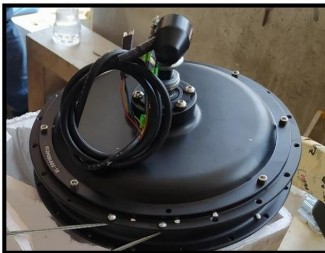
*Nota.* En la figura se representa la estructura del motor eléctrico de 2000W sin la adaptación al aro, en el cual se visualiza las conexiones de las fases de tensión.
