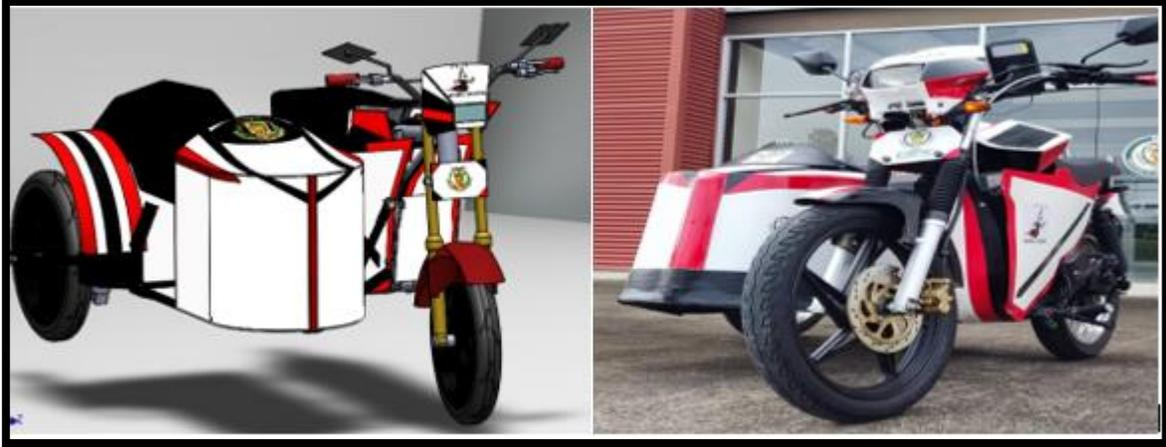
*Nota.* La figura del lado izquierdo representa el modelado en 3D y en el lado derecho se verifica el prototipo BEV real.
