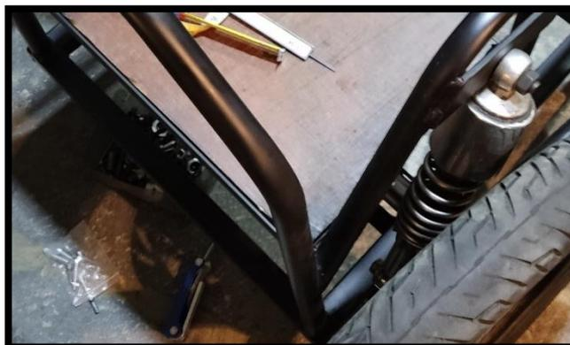
Nota. Se visualiza la correcta instalación en los puntos de anclaje del amortiguador posterior con el bastidor y horquilla del sidecar.
