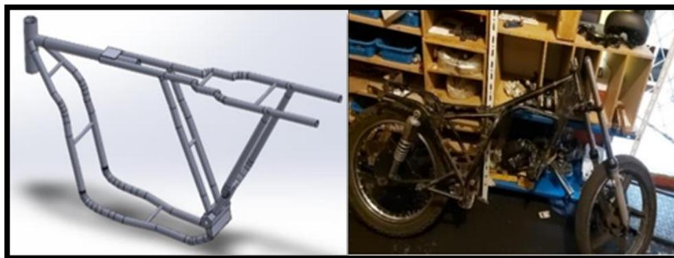
*Nota.* Se presentan los componentes tubulares y estructurales iniciales de la motocicleta antes de su respectiva modificación para la adaptación de los componentes eléctricos y electrónicos. El proceso de unión entre los distintos perfiles tubulares aplicó un método de soldadura SMAW formando en su totalidad un solo conjunto después de realizar el modelado de la misma forma
