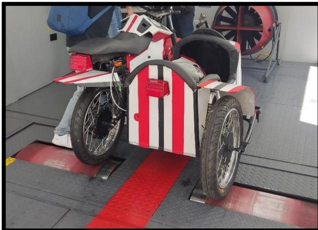
*Nota.* La ubicación de los dos neumáticos con los rodillos giratorios para las respectivas pruebas.
