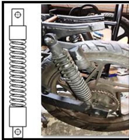
*Nota.* A la izquierda se observa la geometría del amortiguador posterior, a la derecha representa la ubicación y movilidad del amortiguador sin ninguna carga.
