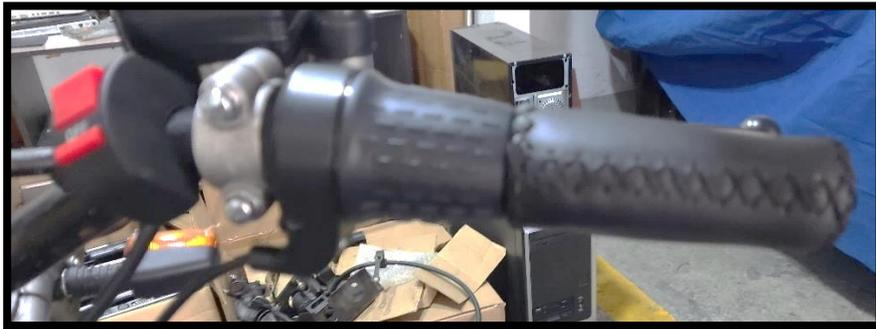
*Nota.* El acelerador se instaló en el volante de la motocicleta con su respectivo cableado para la conexión al controlador.
