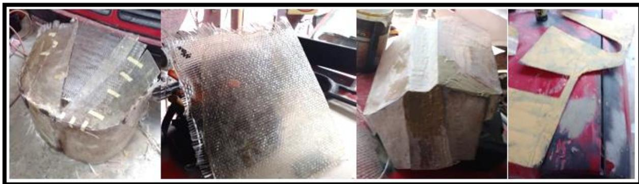
*Nota.* El conformador de la estructura de las piezas con fibra de vidrio, verificando que tenga una buena capa para que no haya deformaciones.
