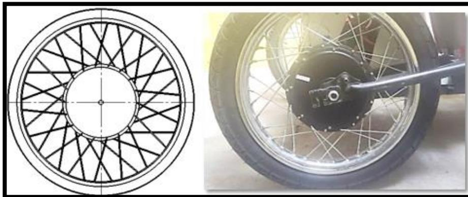
*Nota.* Se representa el boceto y la adaptación de los radios al motor eléctrico del sidecar.
