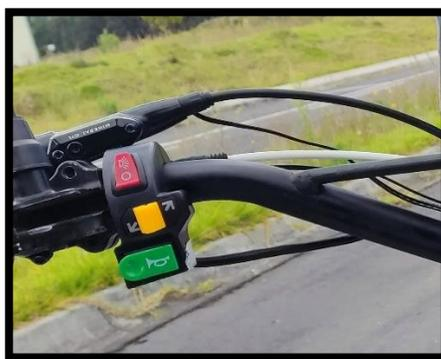
*Nota.* Se realiza la instalación de los mandos de control de las luces, direccionales y bocina en la cual se evidencia que están en lugar cómodo para la buena manipulación del operario.
