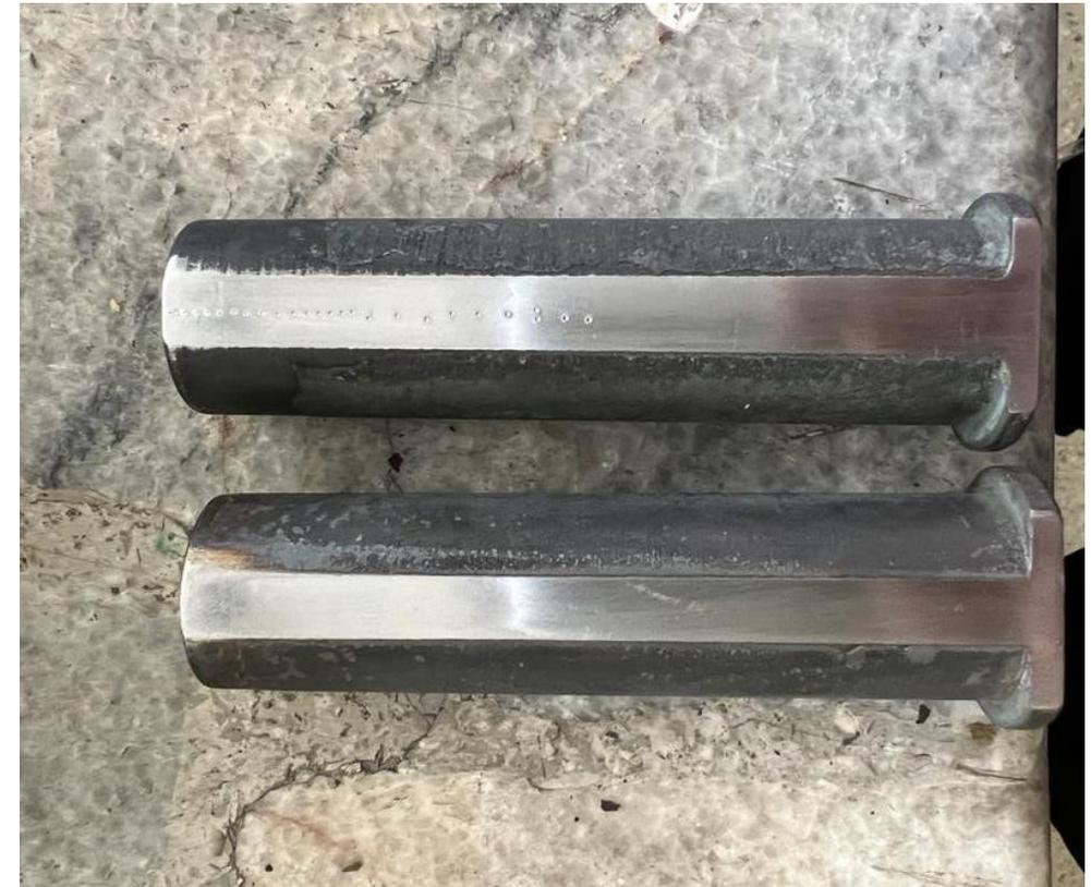
Figura 26. Probeta de Acero AISI 4340
