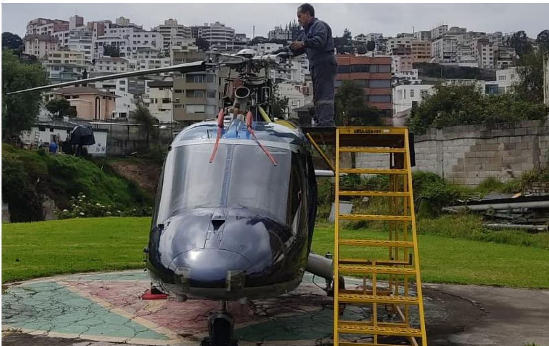
*Nota.* En la figura se observa la verificación de falta de adherencia entre los componentes de las palas.
