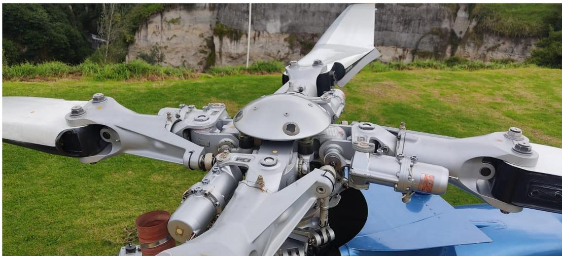
*Nota.* En la figura se observa las palas y elementos de sujeción del rotor principal, los cuales es necesario realizar una inspección y limpieza.
