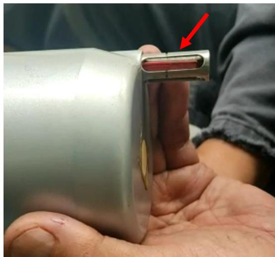
*Nota.* En la figura se observa las marcas de referencia en el indicador de reducción de carga del amortiguador.
