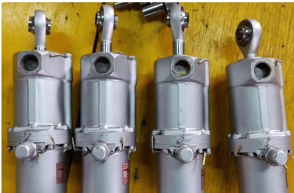
*Nota.* En la figura se observa el desmontaje de los cuatro amortiguadores del rotor principal del helicóptero para poder realizar el test de fugas de los mismos.
