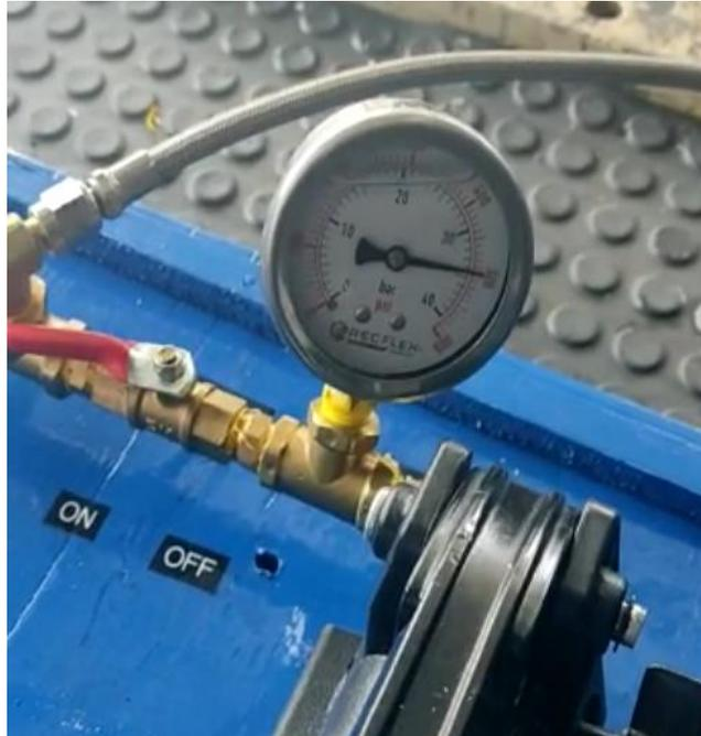
*Nota.* En la figura se observa una presión de 500 psi dentro del amortiguador.
