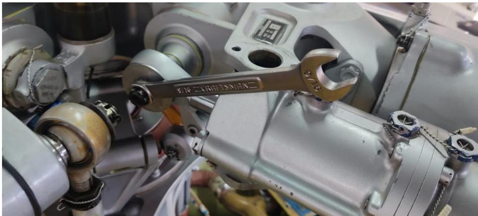
*Nota.* En la figura se observa el desmontaje de los amortiguadores del rotor principal del helicóptero con una llave.
