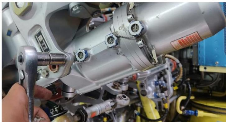
*Nota.* En la figura se observa el desmontaje de los amortiguadores del rotor principal del helicóptero con una racha y copa.
