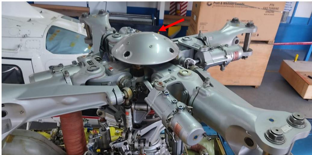
*Nota.* En la figura se observa el desmontaje de la cabeza del rotor principal del helicóptero A109 K2.
