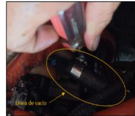
Desconexión de las líneas de vacío en la pared de fuego
