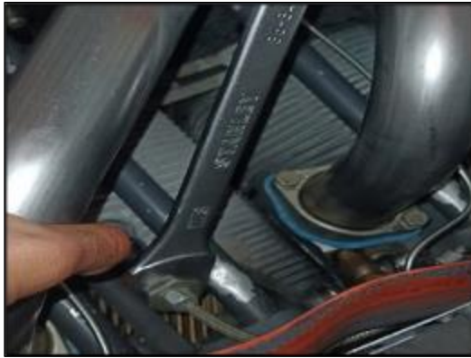
Desconexión de los cables P del magneto
