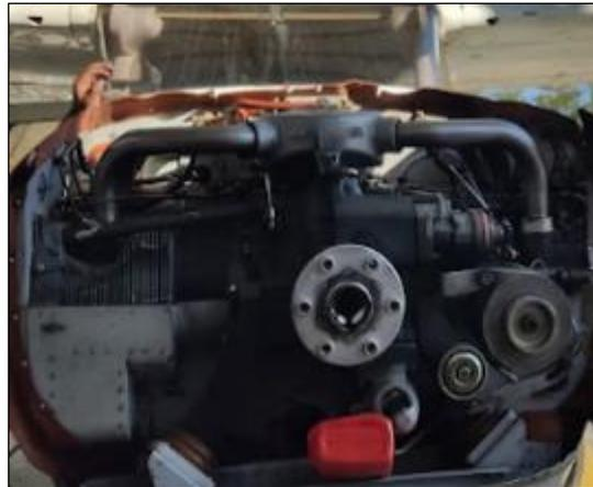
*Nota.* Se colocó un recipiente debajo de la separación del conjunto de la hélice y del motor para evitar que el aceite se esparza por el piso y otros componentes.
