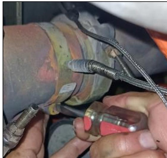
*Nota.* Se utilizó un destornillador plano para aflojar la abrazadera.
