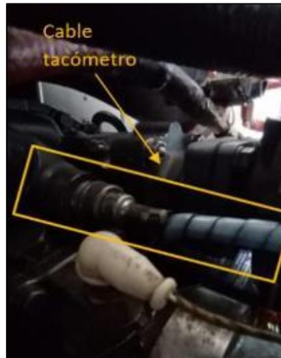
***Desconexión de los cables del motor***
