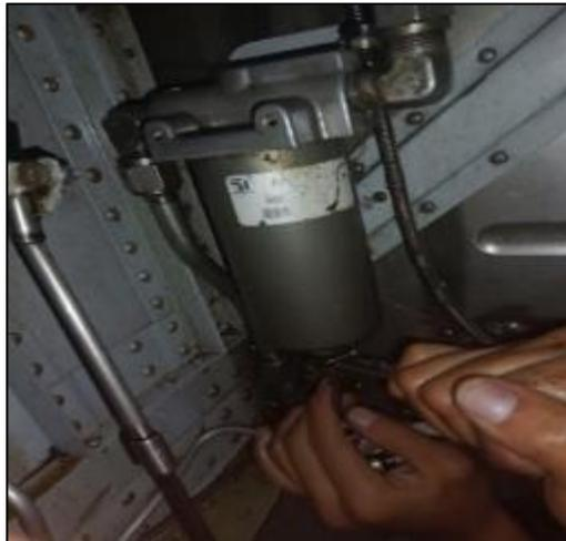
***Desconexión los cables del acelerador y de la mezcla***
