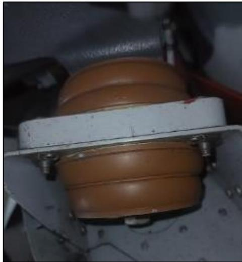
*Nota.* los pernos de sujeción de los soportes de amortiguación del motor fueron retirados con una llave mixta de 5/8 pulgadas.
