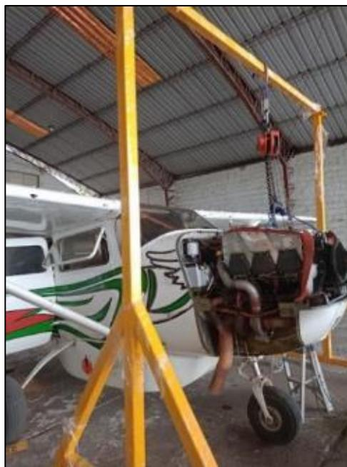
Para el desmontaje del motor se recopiló información del manual de mantenimiento y del IPC (catálogo de partes ilustradas). El proceso fue realizado de acuerdo a los pasos estipulados en el ATA 71 (Power Plant), sección A, parte 1 y 2, de prácticas de mantenimiento del motor del manual de mantenimiento de la aeronave Cessna T206H (Textron Aviation, 2020). Se utilizaron diferentes herramientas manuales, por ejemplo el tecele tipo pórtico que agilizó la elevación y movimiento del motor.
