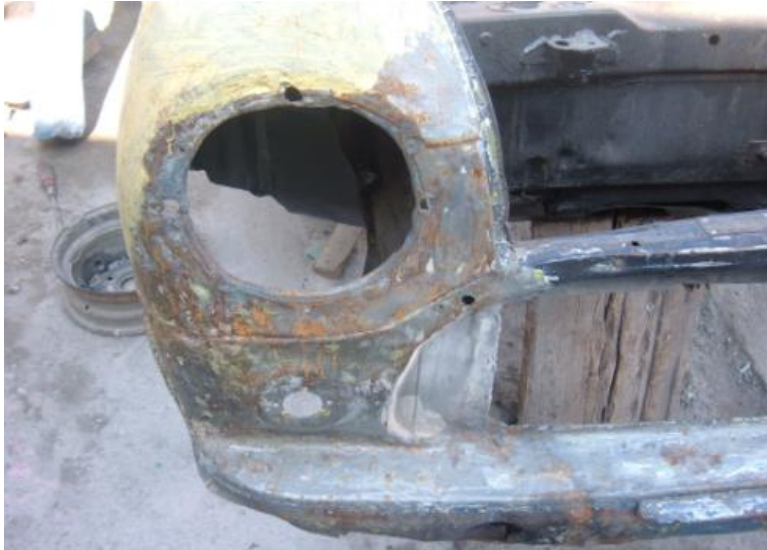
Figura. 5.6 Parte frontal sin masillar.
