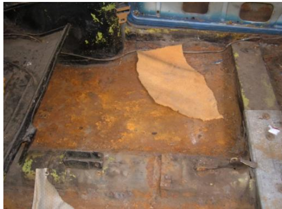
Figura 4.17.- piso posterior deteriorado
