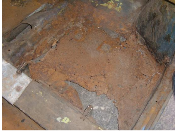
Figura 4.16.- piso delantero deteriorado
