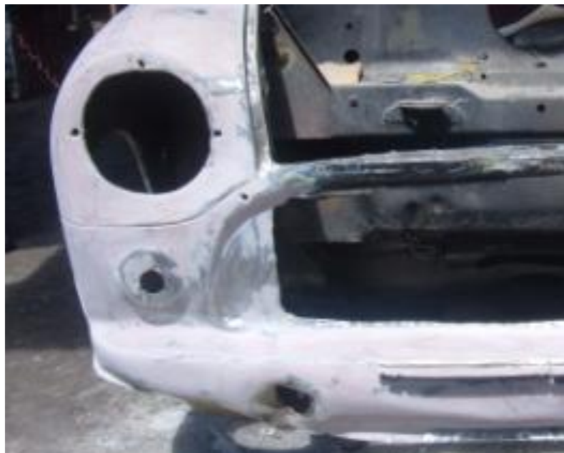
Figura. 5.7 Frontal enderezado y masillado.
