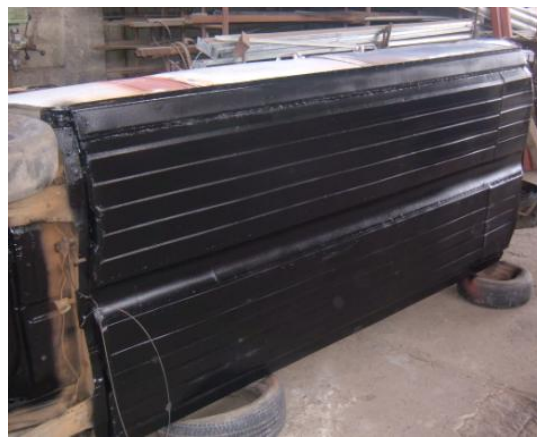
Figura 4.32.- anticorrosivo exterior piso
