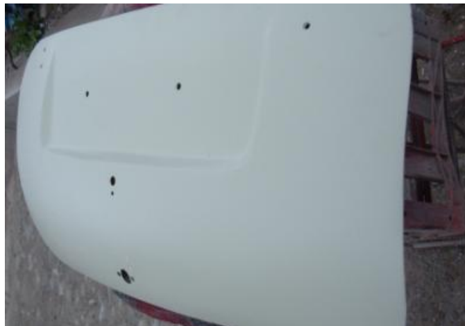
Figura. 5.5 Compuerta después de enderezar.
