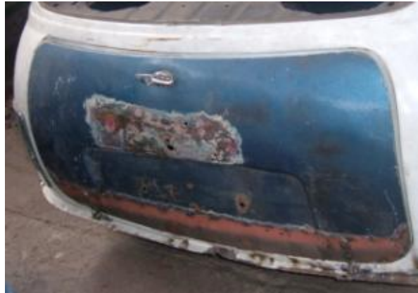
Figura. 5.4 Compuerta antes de enderezar.
