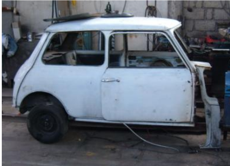
Figura 4.14.- carrocería B cortada vista lateral
