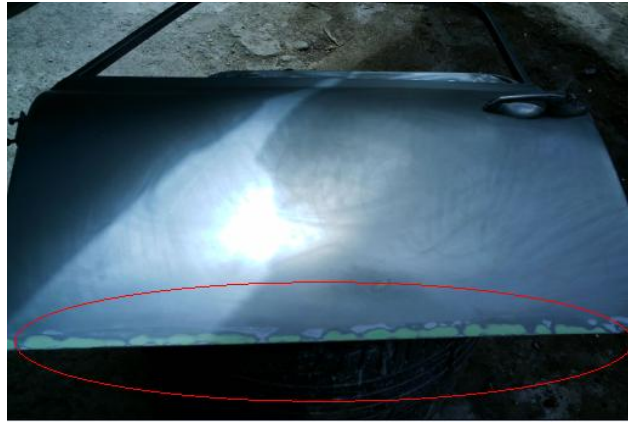
Figura. 5.23 Fallas en la pintura puerta delantera izquierda
