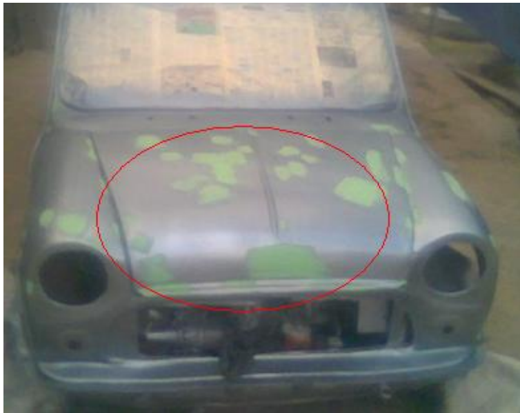
Figura. 5.22 Fallas en la pintura capot
