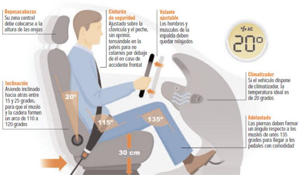
Figura 2.37.- Posición adecuada de conducción
