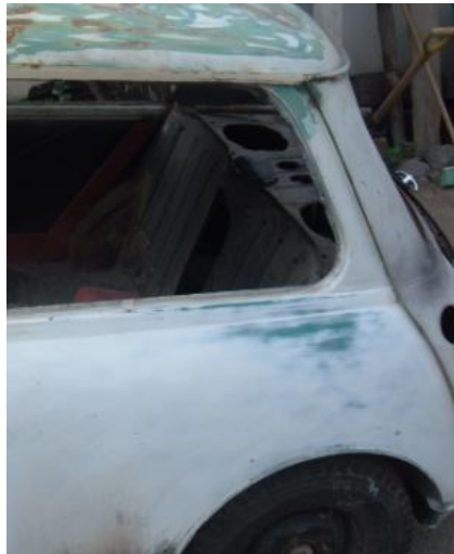
Figura 5.2 Panel esmerilado y sacado pintura vieja
