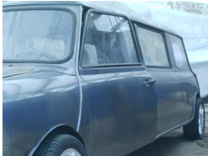
Figura. 5.25 Segunda mano de pintura puerta delantera y parte lateral
