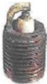
Figura 3.14 Bujía sobrecalentada levemente
