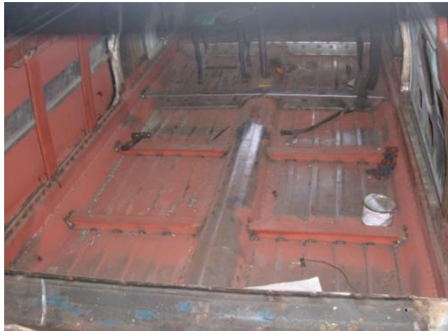
Figura 4.28.- soldadura refuerzos del piso
