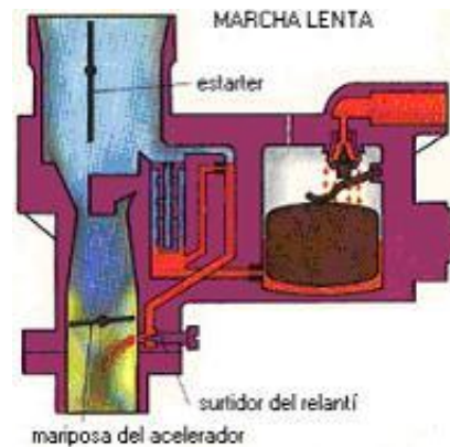
Figura. 3.7 Marcha lenta del carburador
