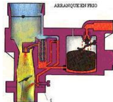
Figura. 3.10 Arranque en frío del carburador.
