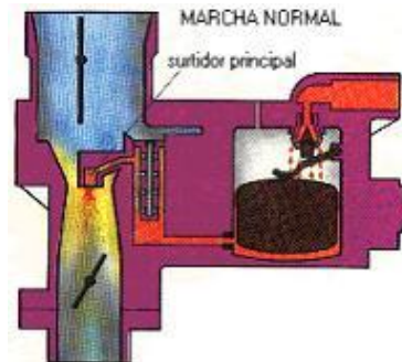
Figura 3.9 Marcha normal del carburador.
