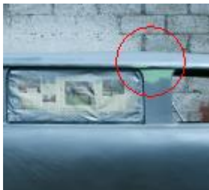
Figura. 5.20 Falla parante posterior izquierdo.
