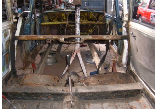
Figura 4.18.-extracción parcial piso deteriorado
