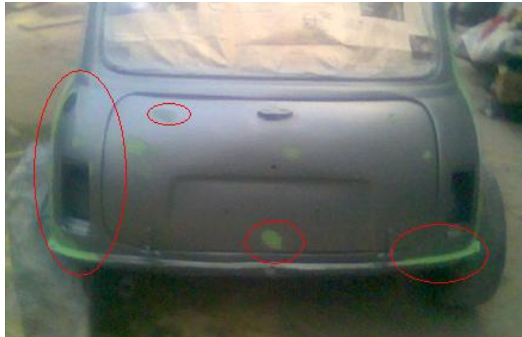
Figura. 5.21 Fallas en la pintura compuerta
