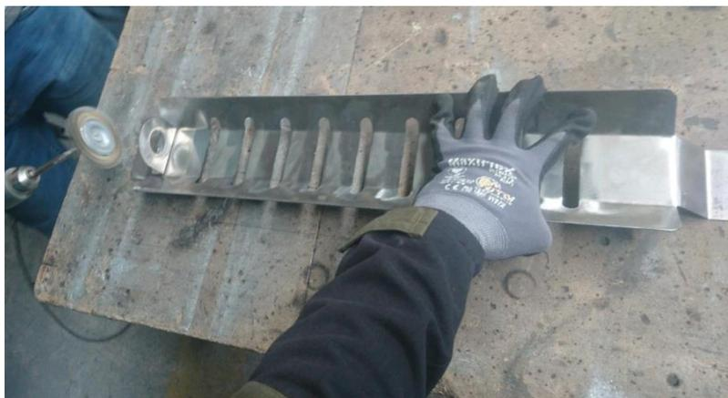
Las piezas metálicas, toman su forma final, gracias a las dobladoras hidráulicas, para luego ser ensambladas entre sí y fijadas con soldadura MIG.
