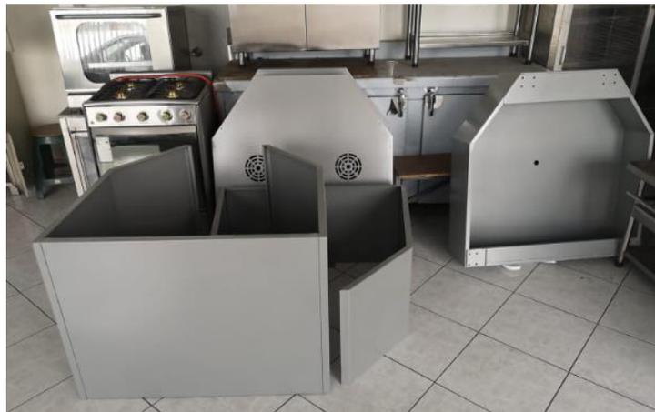
A continuación, cada una de las partes se ensamblan de manera cuidadosa, mediante la utilización de tornillos tirafondo de  $\frac{1}{4}$  de pulgada, ya que su propósito se centra en la unión de elementos desmontables de gran peso.
