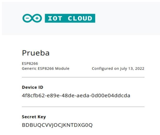
Para agregar las variables a la plataforma se debe crear un Thing, dentro de este se registran las variables que se van a utilizar, tal como se observa en la Figura 79, además de que se define el dispositivo que se va a usar.
