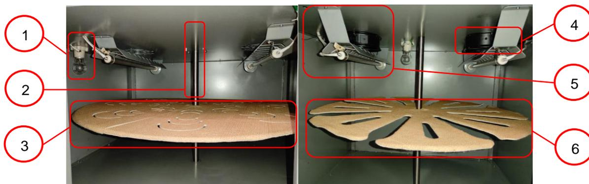
*Nota.* La diferente posición de la bombilla en la cámara superior se debe a que la vista del operario no reciba directamente el resplandor al momento de cargar o descargar el producto.
