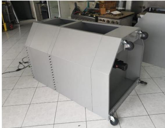
Al ser un requerimiento expreso, la activación del motor para cargar y descargar las capelladas en horma y las suelas debe darse por medio del pedal eléctrico tipo Switch, por ende, se realiza la respectiva conexión.
