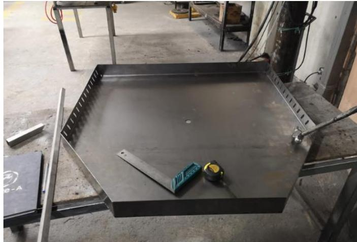
Las paredes de las cámaras de calentamiento deben ser soldadas temporalmente para dimensionar los agujeros de pernos y tornillos de una manera precisa.
