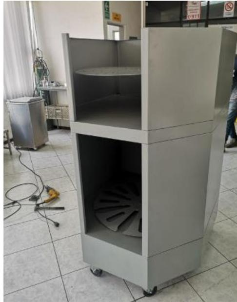
Seguidamente se recuesta la estructura ya ensamblada para adaptar el motor eléctrico proporcionado por la empresa Ciara al eje central, cuyo material es un tubo de acero inoxidable de 1 pulgada de diámetro \* 1.5 mm de espesor.
