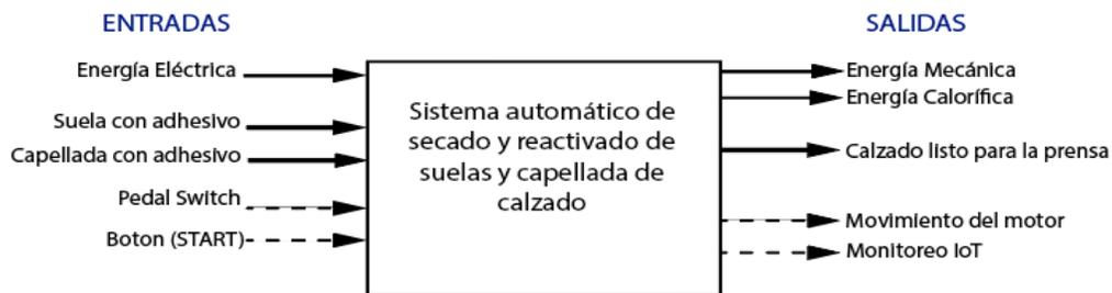
Una vez establecida la función global del sistema automático de secado y reactivado de suelas y capellada se puede desglosar las siguientes subfunciones:
