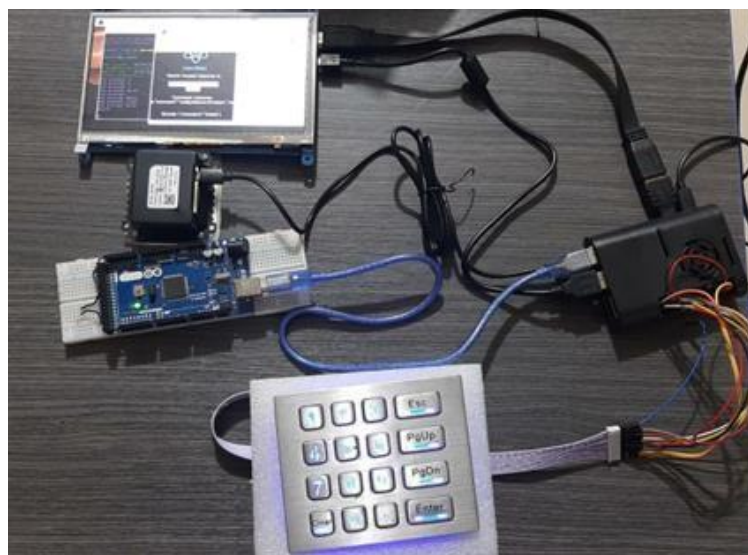
Conexión de periféricos a la Raspberry Pi 4
