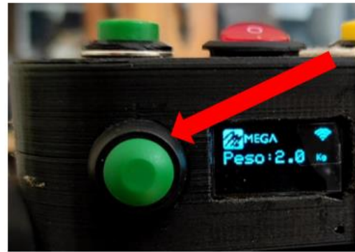
Pulsador para registro de máquinas transportadas.
