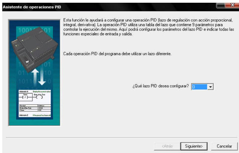
**Figura 2.10 Asistente de configuración PID**
