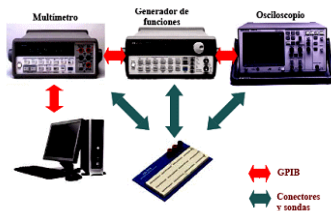
Fig 2.61. Esquema de instrumentos virtuales en un laboratorio
