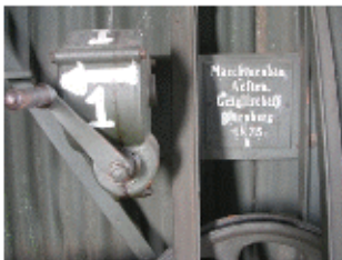
Tornillo sinfín para abrir compuerta superior 1
