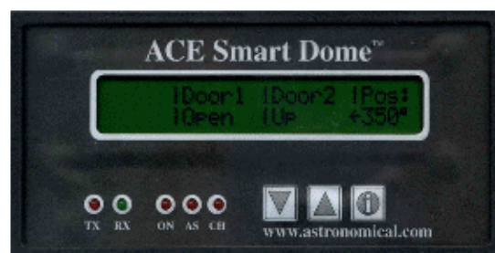
Fig. 1.91: Display y botones de comando en el panel de un microcontrolador para domo
