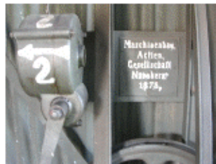
Tornillo sinfín para abrir compuerta superior 2
