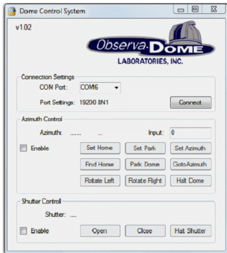
Fig. 1.97: Ventana del software de sistema de control de domo “Observa – dome”, mostrando configuración de comunicaciones, control de azimut y control de compuertas.
