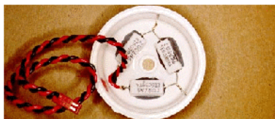
Fig. 1.85: Detalle de la parte superior del sensor, mostrando el arreglo de termopilas que sirve para la medición de temperatura de las nubes
