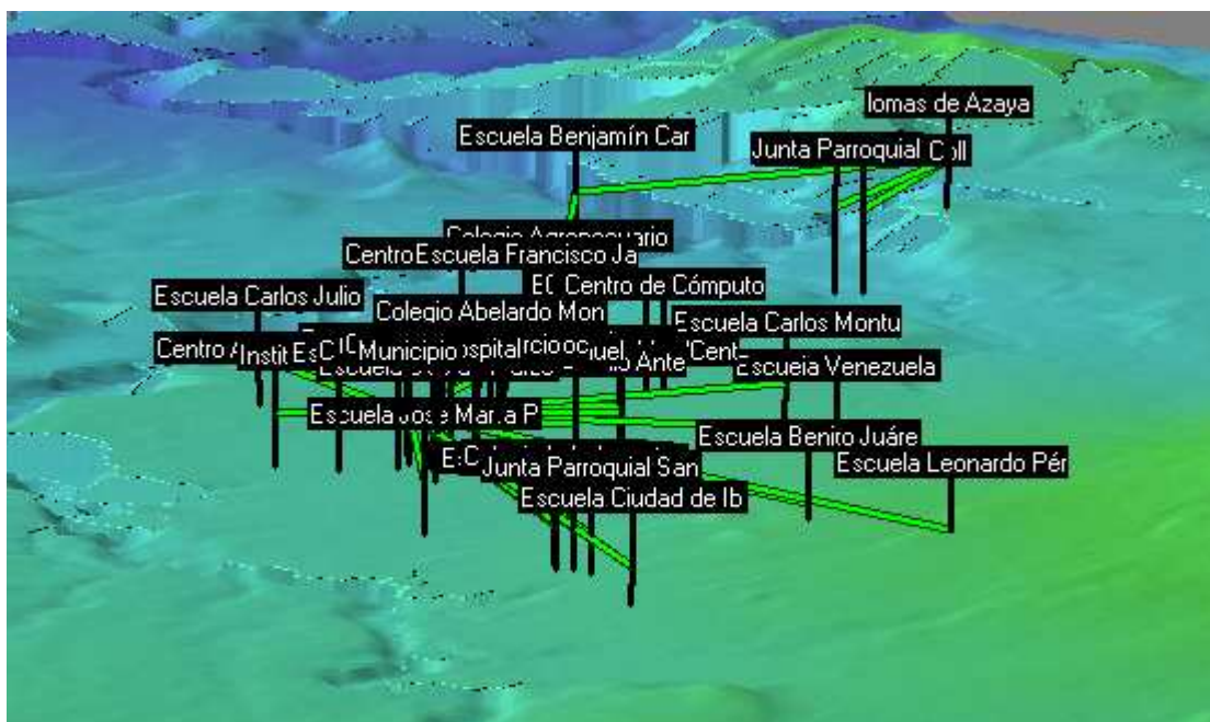
Figura 4. 52 Vista en 3D del Enlace (Radio Link)
