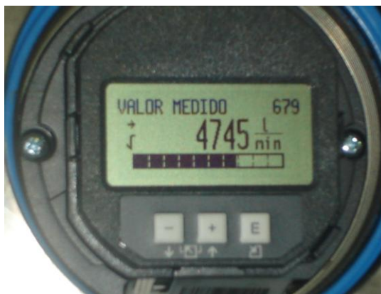
Figura 2.10. Interfase LCD externo del Transmisor PMD75
