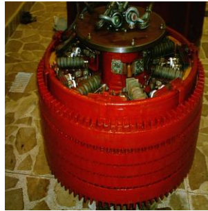
Figura 1.6. Bobinado rotativo de la excitatriz con sus diodos rotativos
