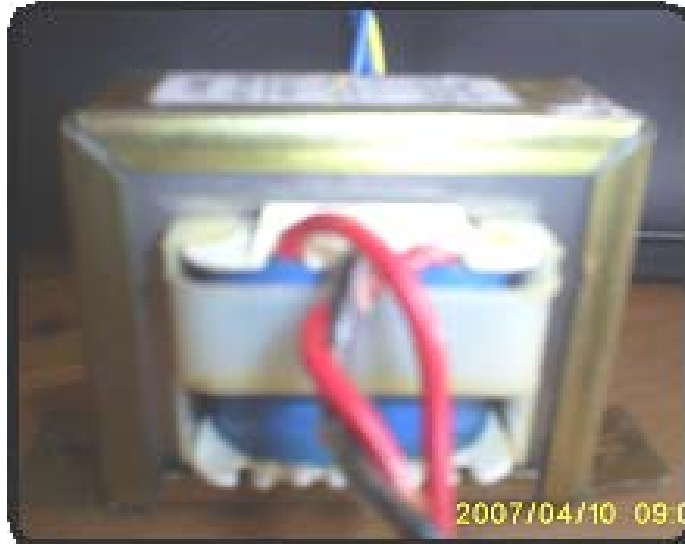
Figura 2.5: Transformador reductor de potencial de 110V a 9V
