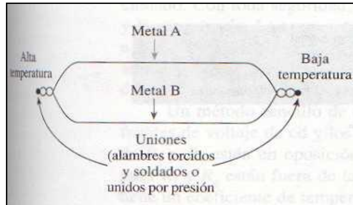
Fig. 1.8. Configuración Interna de la Termocupla
