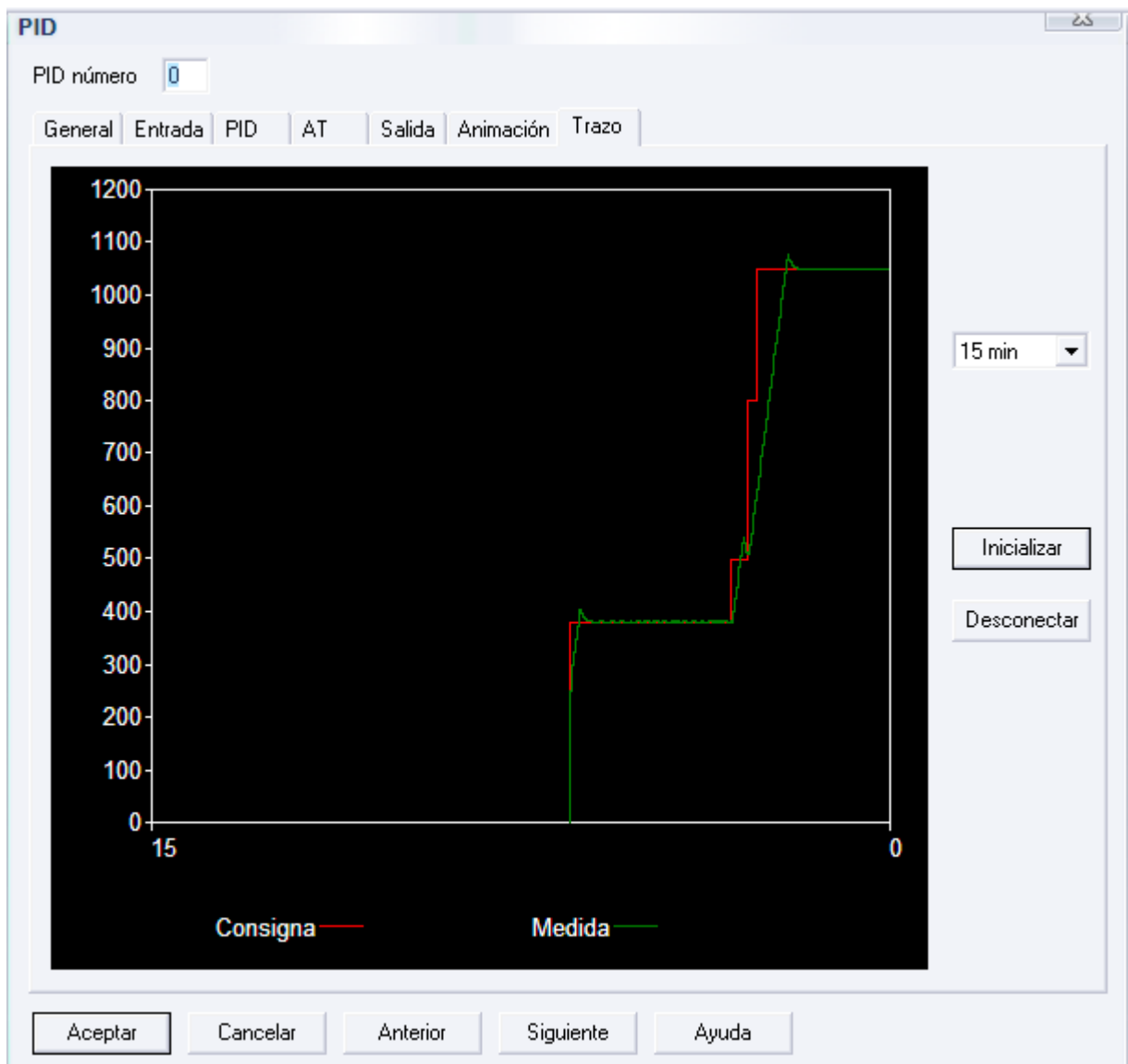
Fig. 3.3. Curva de respuesta de velocidad media a 38 Hz y velocidad alta a 105 Hz
