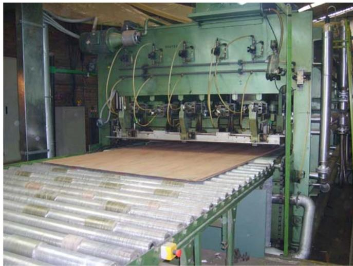
**Figura 1.2 Vista de una sección de la prensa BURKLE**
