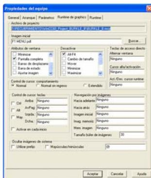
**Figura 2.36 Configuración de la visualización de las ventanas en el runtime y otras propiedades del proyecto.**
