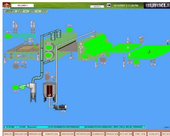
En el caso de que un motor cumpla con las horas de servicio seteadas (acceso a la ventana de seteo de horas servicio, botón [MTTO MOT] ), a un costado del motor aparecerá un símbolo de una “mano con una llave” titilando indicando que ese motor necesita que se le
