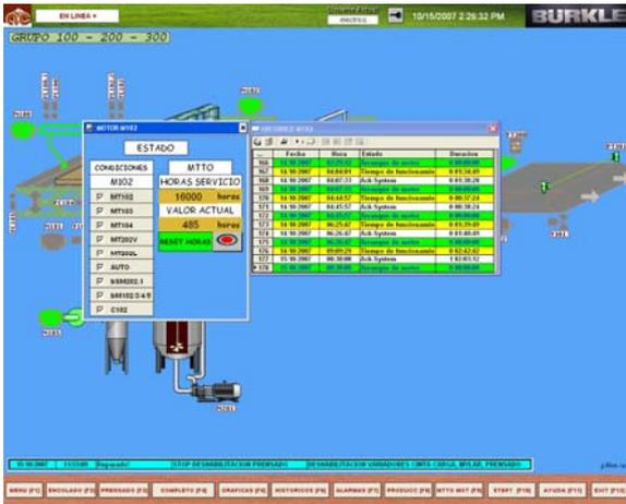
Figura 2.41 Ventana en la cual se visualiza el estado de las condiciones de arranque del motor M102, así como sus horas de funcionamiento y el histórico de arranque y parada del motor.
