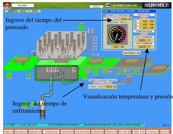
Dando clic en el botón “MANOMETROS”, se puede observar una subventana en la que se encuentran los mismos, mediante un instrumento virtual analógico, y además se puede ver las presiones a que cilindros o pistones corresponden.
