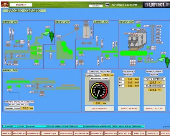
Figura 2.42 Ventana en la cual se visualiza todo el proceso de enchapado del tablero
