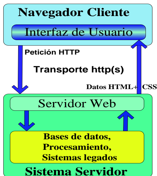
Figura 3.6: Modelo Clásico de aplicación Web
