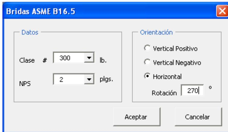
Figura 7.22. Ingreso de datos para la brida de la boca #3
