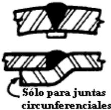
Junta a tope de una pasada con placa de respaldo, la cual debe ser removida después de la soldadura.
