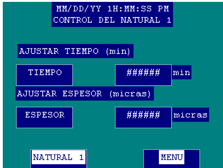
Fig. 2.37 Vista de la pantalla Control del Natural 1.
