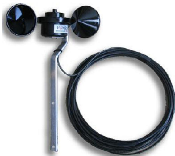
Fig. 1.9 Inspeed Vortex Wind Sensor: el anemómetro estándar.
