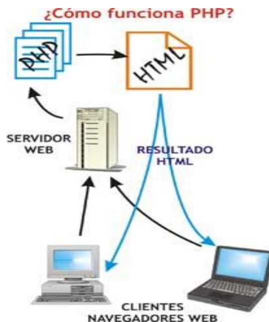
Fig. 3.1 Funcionamiento de PHP.
