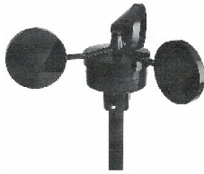
Fig. 2.8 Anemómetro de copas Vortex Inspeed.
