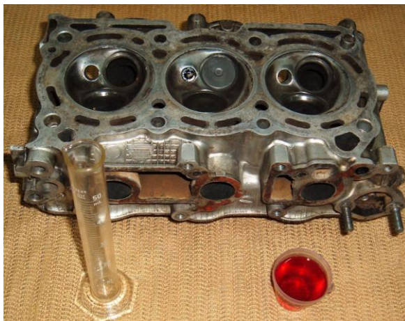
FIGURA 5.2 Medición del Volumen de la Cámara de Combustión
