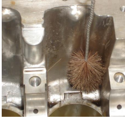
FIGURA 4.7 Limpieza y Desincrustación de Conductos
