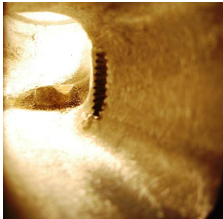
FIGURA 5.20 Espárrago interno de Refuerzo (Conducto de Escape)
