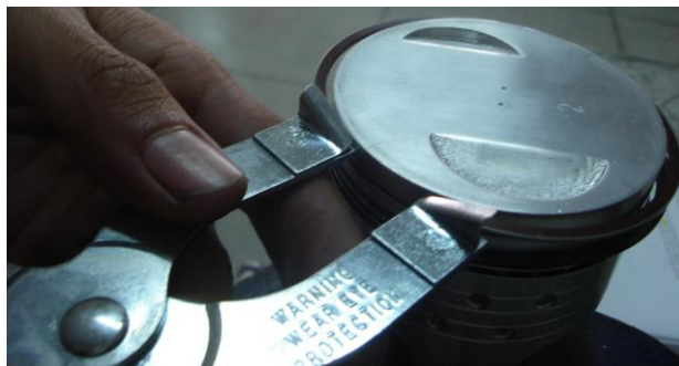
FIGURA 4.29 Instalación de los Rines
