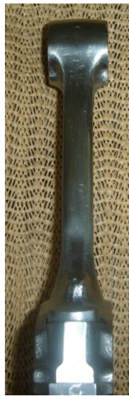
FIGURA 4.37 Pulido de la Biela (Acabado Final)
