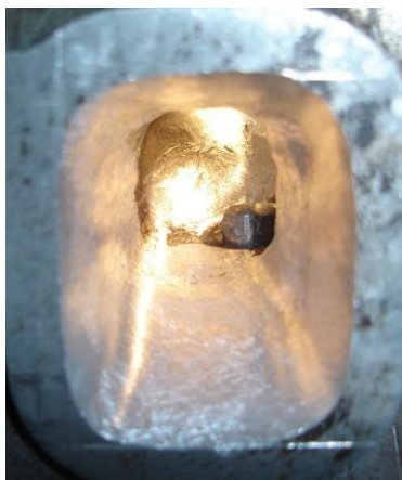
FIGURA 5.21 Mecanizado del Conducto de Escape (Fase 2)
