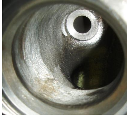
FIGURA 5.11 Reparación en Frío del Conducto de Admisión
