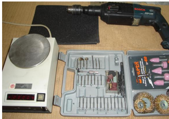
FIGURA 4.24 Equipo de Aligerado de Masas
