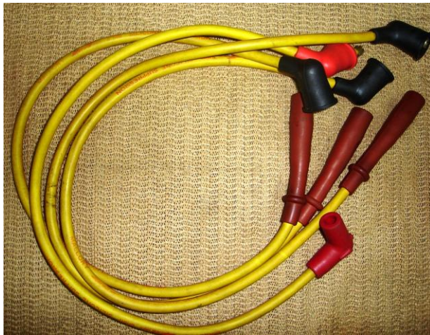
FIGURA 9.6 Cables de Alta Tensión Mallory – Sprint 8mm
