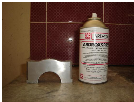
FIGURA 4.9 Tintas Penetrantes (Paso 1)
