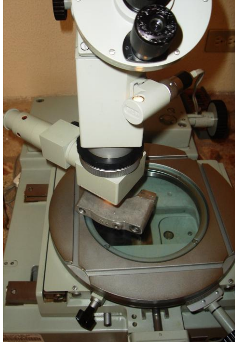
FIGURA 4.8 Inspección Visual Vía Microscopio
