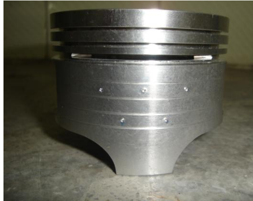
FIGURA 4.20 Perforaciones en la Falda (Marcas de Referencia)
