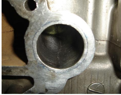
FIGURA 5.7 Trazado del Diámetro Externo (Conducto de Admisión)
