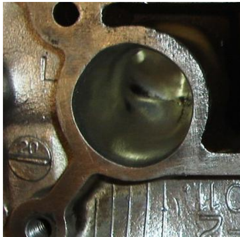
FIGURA 5.13 Pulido del Conducto de Admisión (Acabado Final)
