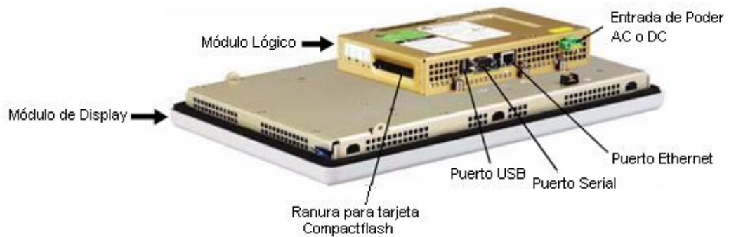
Figura 2.16: Unidad Básica de Configuración de un PanelView Plus 700
