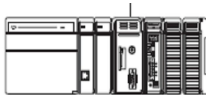
Figura 2.8. CompactLogix L43 con módulo de Comunicación EtherNet/IP 1768-ENBT
