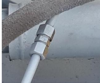
*Nota.* En la imagen se puede identificar el acople que se utilizó para unir la cañería de alta presión con el mecanismo de dirección.
