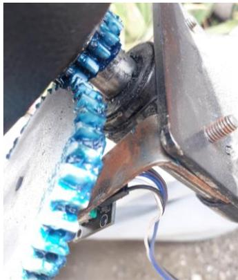
*Nota.* En la imagen se puede identificar el acoplamiento de una placa que sujeta el encoder.
