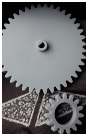
*Nota.* En la imagen se puede identificar los engranajes que se utilizaran para la transmisión de giro del volante hacia el Arduino UNO.
