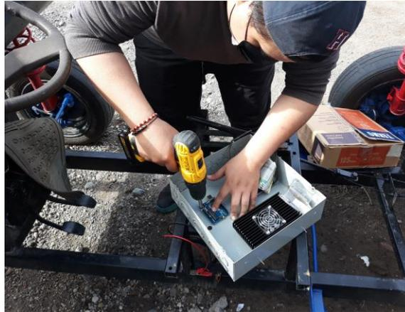
*Nota.* En la imagen se puede identificar como están siendo fijados los componentes para el control electrónico.
