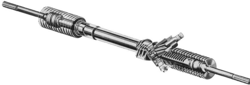
*Nota.* En la imagen se puede identificar un sistema de cremallera con accionamiento lateral y barras de dirección en los extremos. Tomado de (Velasco, Oliva y Sánchez, s.f.).
