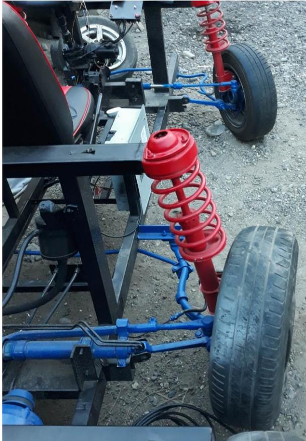
*Nota.* En la imagen se puede identificar como como trabaja el sistema de dirección a las 4 ruedas cuando se ha girado el volante hacia la izquierda.
