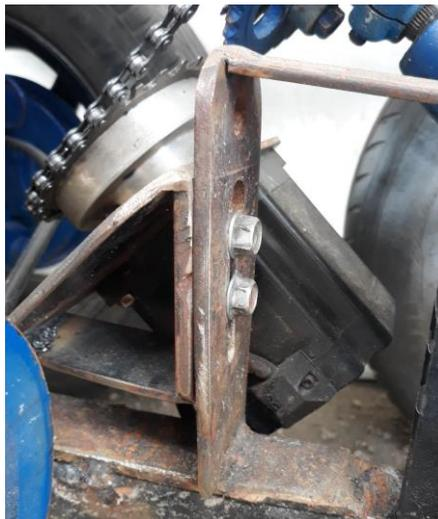
*Nota.* En la imagen se puede identificar la adaptación de una base que sujetará el actuador.
