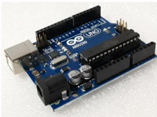
*Nota.* En la imagen se puede identificar un Arduino UNO.
