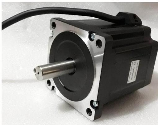
*Nota.* En la imagen se puede identificar el actuador seleccionado para la dirección a las ruedas posteriores.
