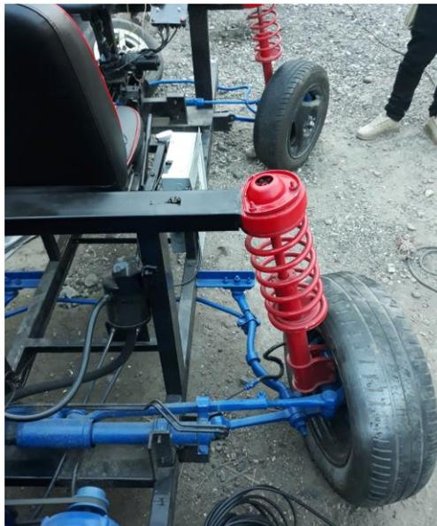
*Nota.* En la imagen se puede identificar como trabaja el sistema de dirección a las 4 ruedas cuando se ha girado el volante hacia la derecha.
