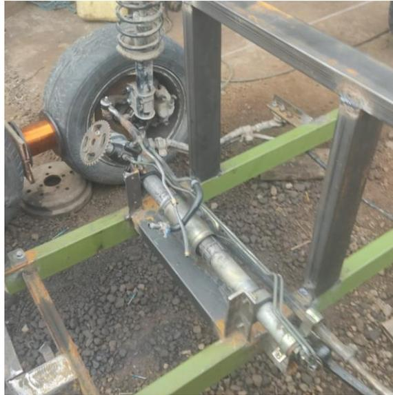
*Nota.* En la imagen se puede identificar la adaptación del mecanismo de dirección hidráulica se realizó en la parte posterior.
