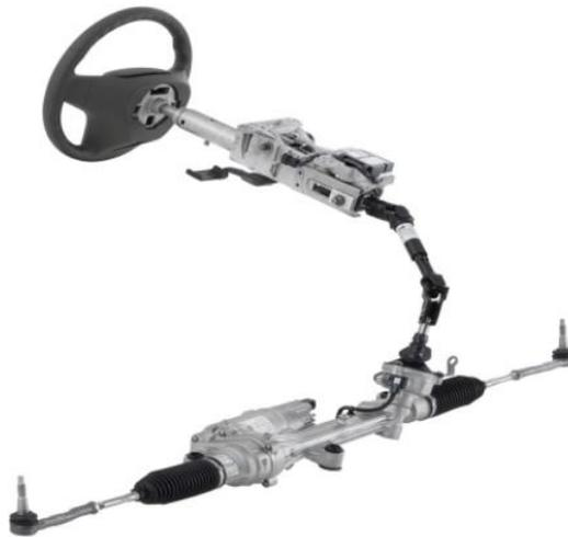
*Nota.* En la imagen se puede identificar el sistema completo de la dirección asistida electrónicamente EPS. Tomado de (Palomino, 2020)
