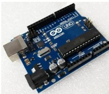
*Nota.* En la imagen se puede identificar el Arduino seleccionado para la unidad de control electrónico de la dirección a las ruedas posteriores.
