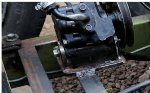
*Nota.* En la imagen se puede identificar la base de la bomba adaptada en la estructura.
