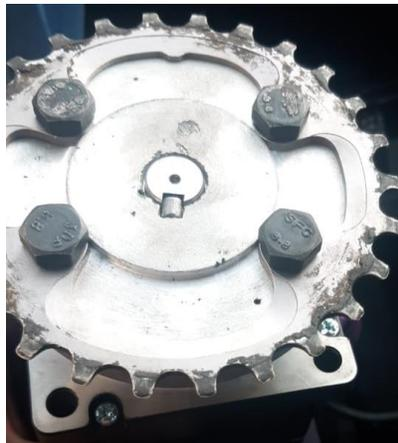
*Nota.* En la imagen se puede identificar la adaptación que se realizó en el actuador.
