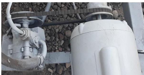
*Nota.* En la imagen se puede identificar la banda instalada entre el motor y la bomba.
