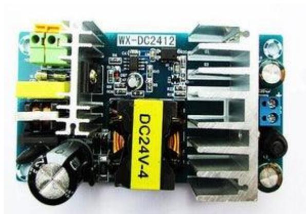
*Nota.* En la imagen se puede identificar el sistema de alimentación que se utilizará. Tomado de (arcaelectronica, s.f.)
