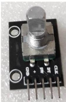
*Nota.* En la imagen se puede identificar el encoder que se utilizará.
