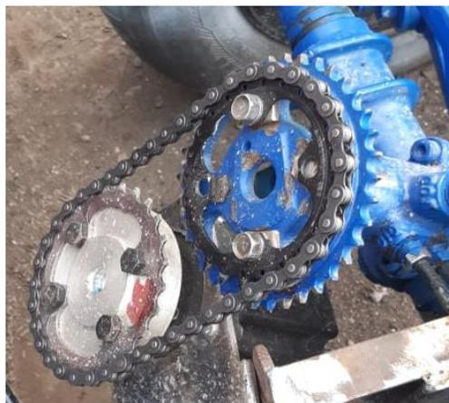
*Nota.* En la imagen se puede identificar la adaptación del sistema de transmisión para la dirección de las ruedas posteriores.
