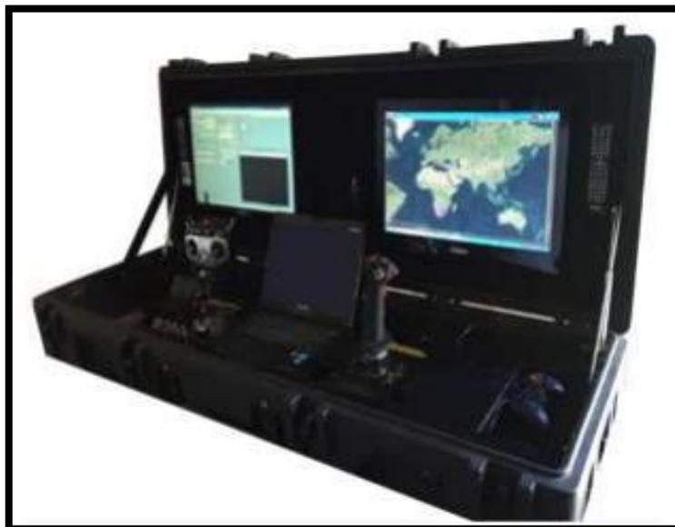
*Nota. Vista de una estación en tierra física para el monitoreo de un enjambre de UAVs. (SUQUI CONGACHA & PAREDES CARRILLO, 2019)*
