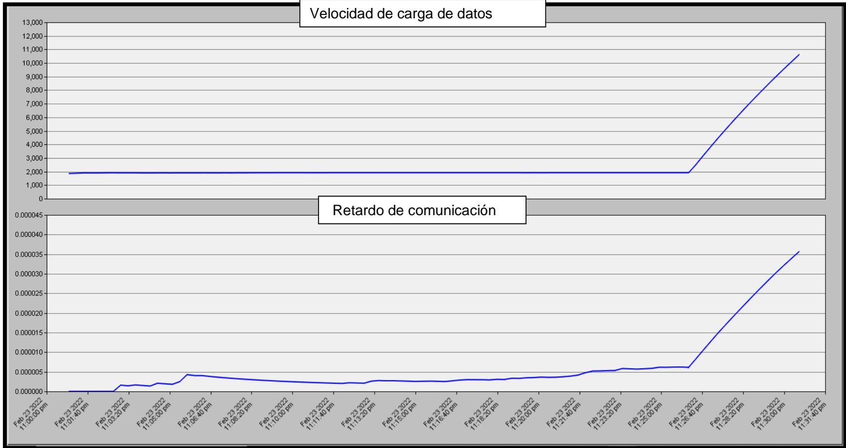
Nota. Velocidad de carga de datos y retardo de comunicación con el protocolo OLSR y protocolo físico Tarifa extendida PHY (802.11g).
