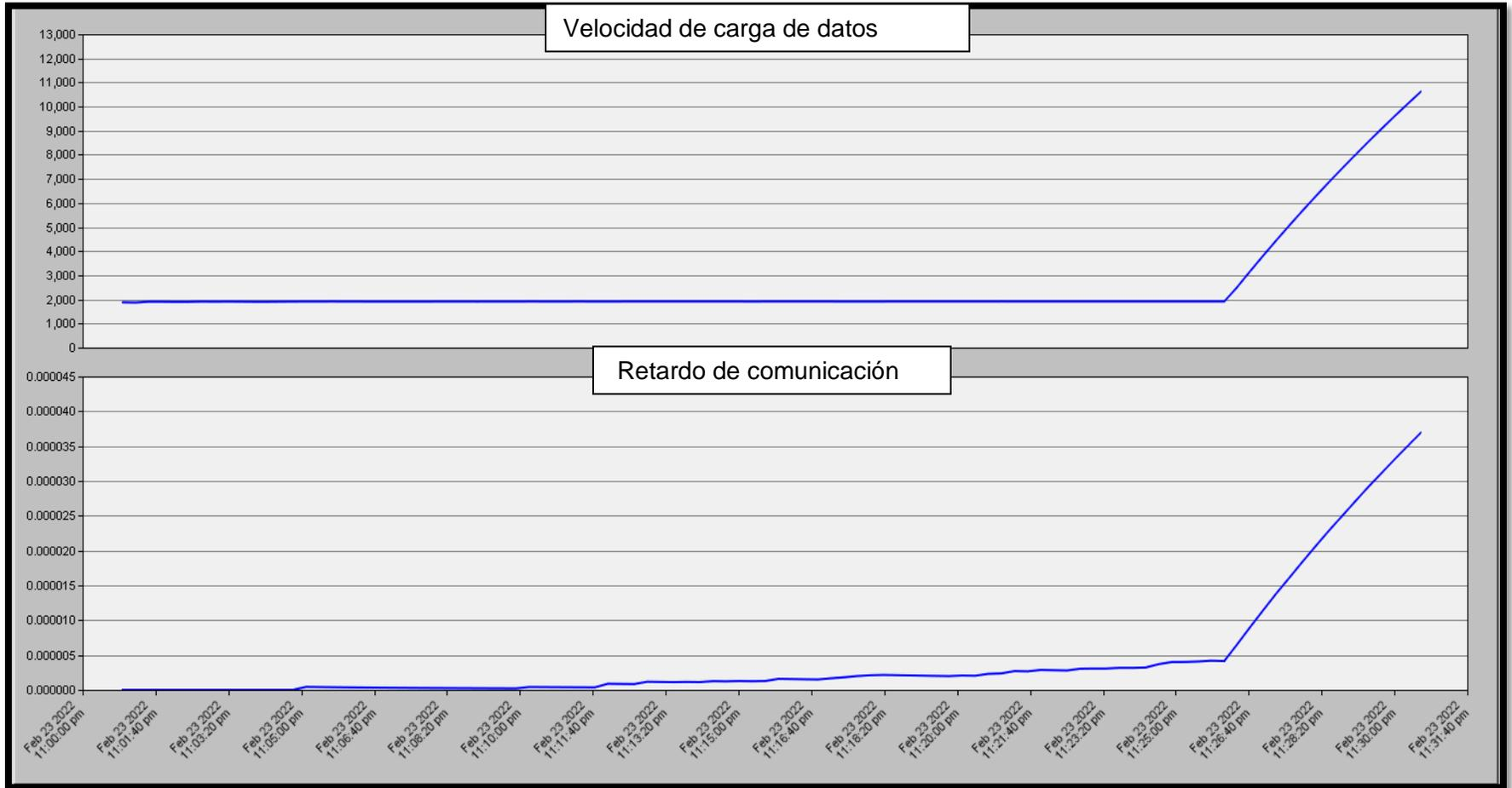
Nota. Velocidad de carga de datos y retardo de comunicación con el protocolo OLSR y protocolo físico Infrared.
