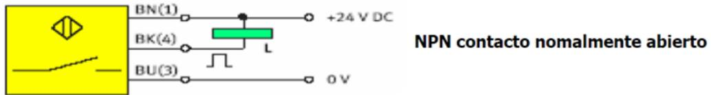
Figura 2.27. Conexión del sensor.
