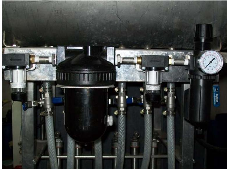
Figura 2.24. Unidad de purificación del aire.
