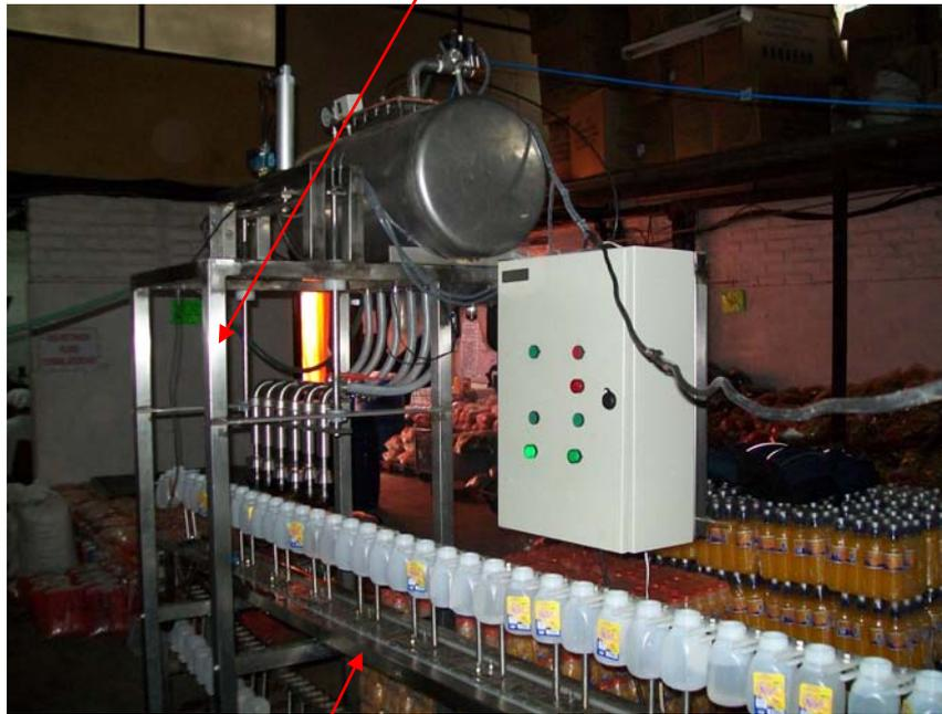
Estructura para la cadena transportadora
