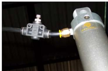
Figura 2.18. Reguladora unidireccional.
