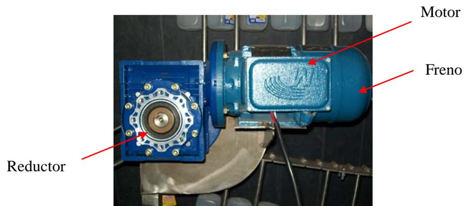
Figura 2.32. Motor reductor con freno electromagnético.
