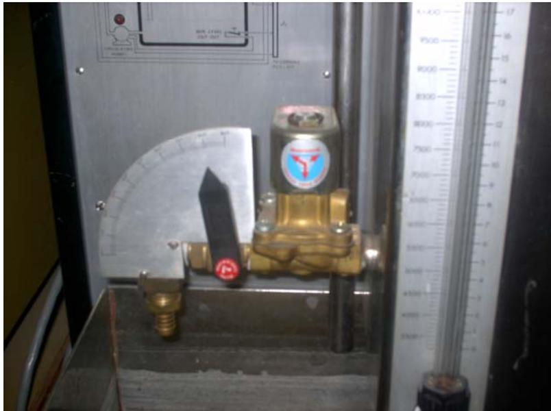
**Válvula para vaciado del tanque**
