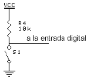
Figura 1.19 Conexión clásica de un switch
