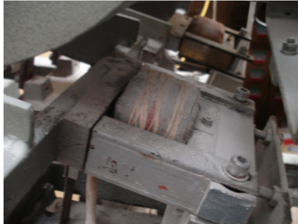
FIGURA 1.3 Vibradores de las bandejas transportadoras de producto.
