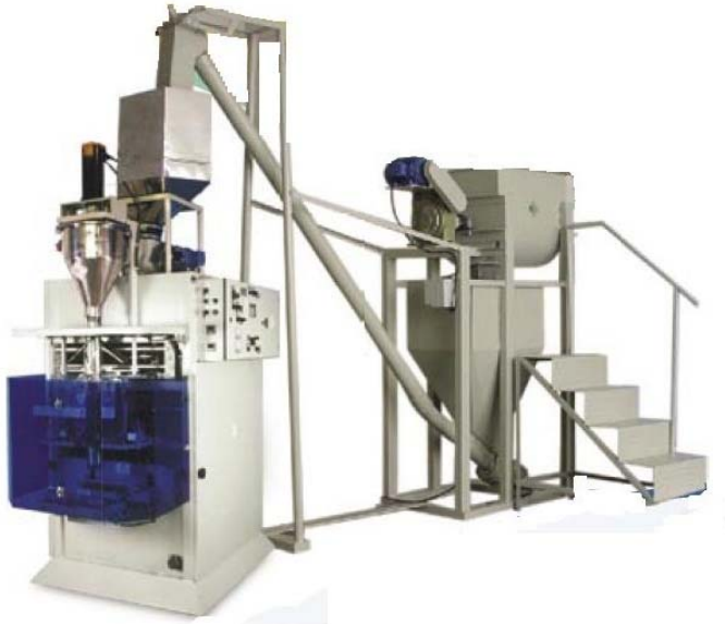
Figura 1.1 Máquina Automática Selladora y Pesadora de Fideo
