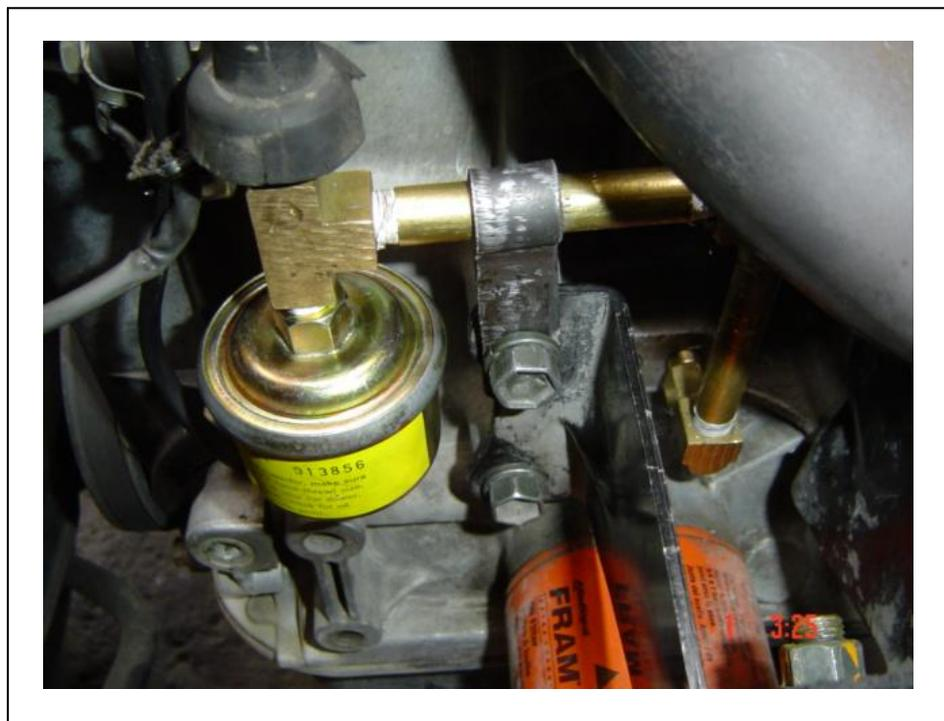
Figura 5.17.- Instalación de los trompos de presión de aceite
