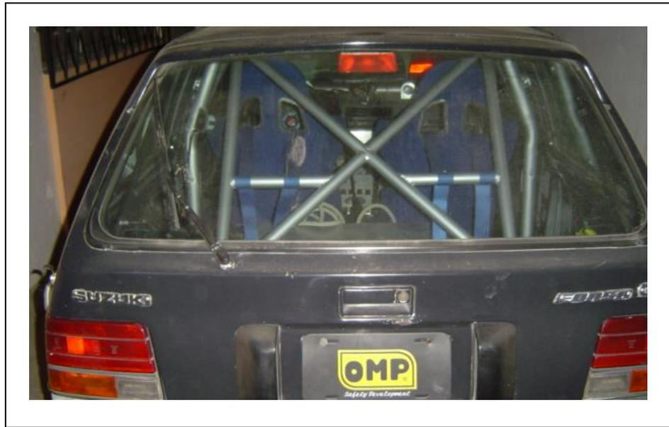
Figura 5.7.- Faro adicional de luz de freno
