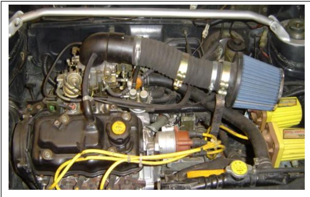
Figura 5.22.- Cables utilizados en el sistema de encendido del vehículo de rally
