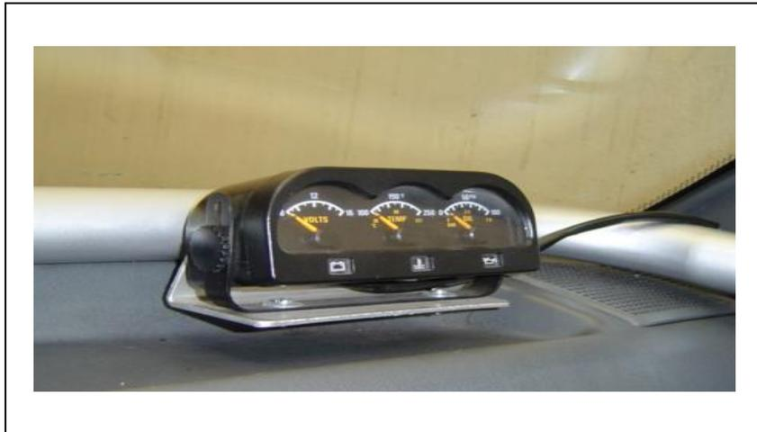
Figura 4.7.- Voltímetro utilizado en vehículo SUZUKI FORSA 1 DE RALLY
