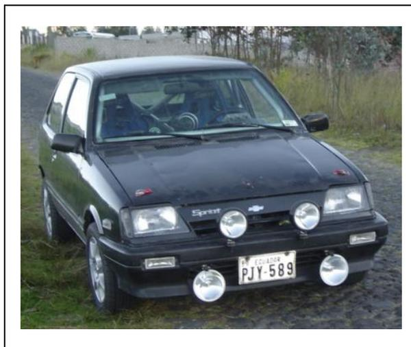
Figura 5.6.- Faros antiniebla utilizados en el vehículo SUZUKI FORSA 1 de Rally
