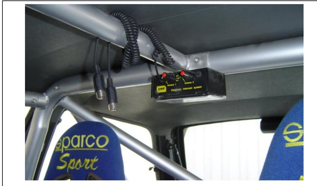
Figura 5.26.- Ubicación de la centralita del sistema de comunicación o peltor
