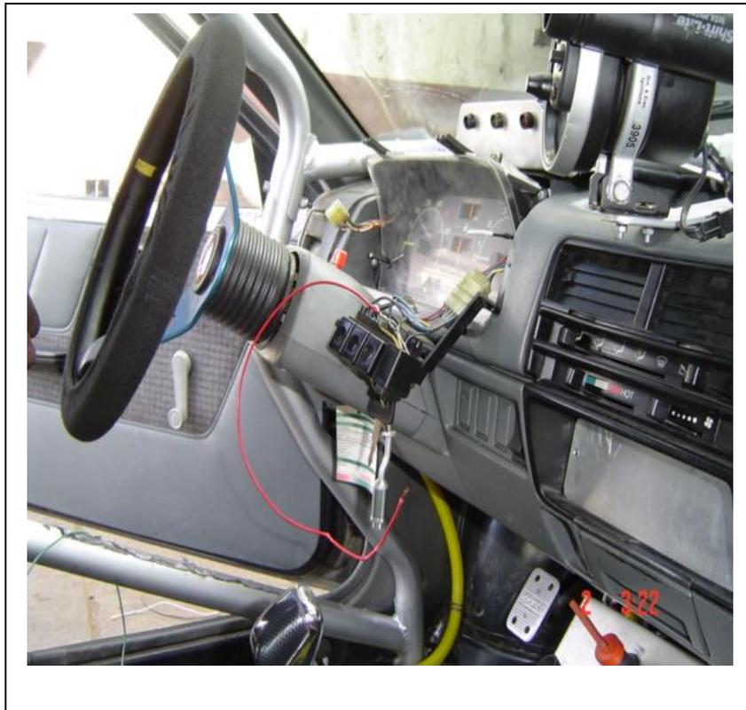
Figura 5.23.- Conexión del pulsador del limpia parabrisa
