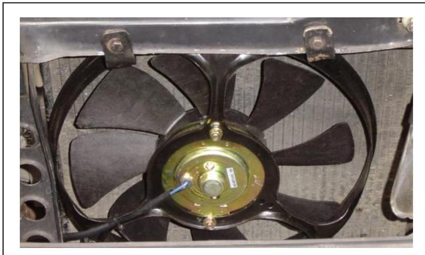
Figura 5.10.- Ventilador adicional del sistema de refrigeración
