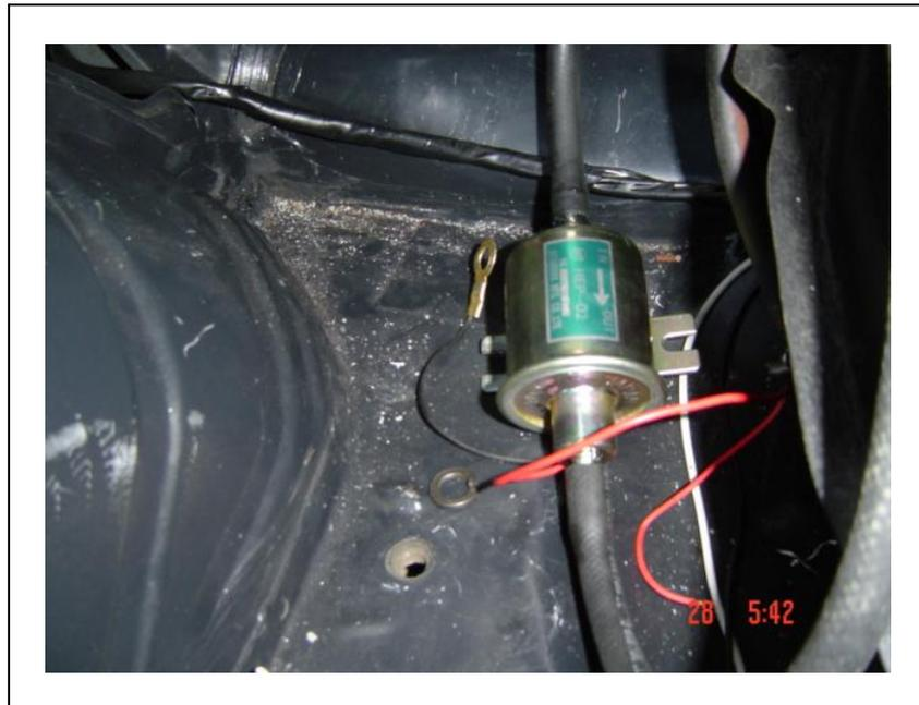
Figura 5.15.- Instalación de la bomba eléctrica de combustible
