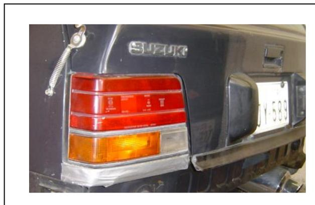
Figura 2.10.-faro posterior con las luces de maniobra
