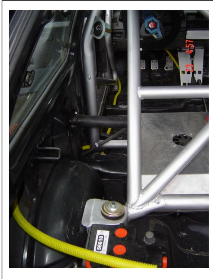
Figura 5.2.- Cableado de la batería al swich master
