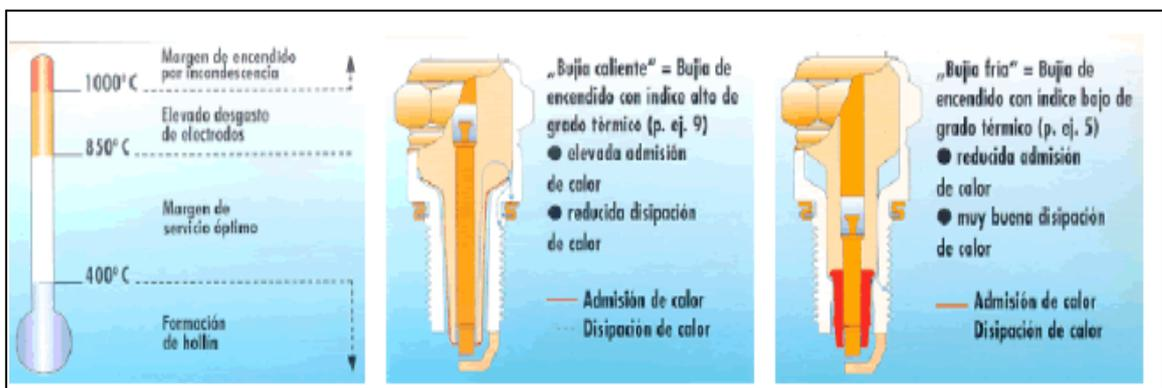
Figura 3.4.- Grado térmico de las bujías
