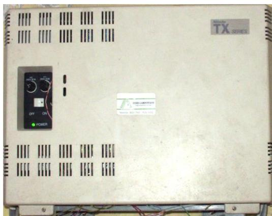
**FIGURA 1.3: Forma Física de la central telefónica NITSOKO TX SERIES 2464<sup>7</sup>**
