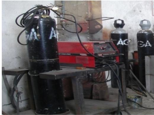
Fig. 3.8: Sistema actual utilizado para el proceso de soldadura TIG.
