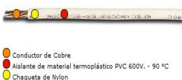
Fig.1.2: Detalles del conductor de cobre tipo THHN
