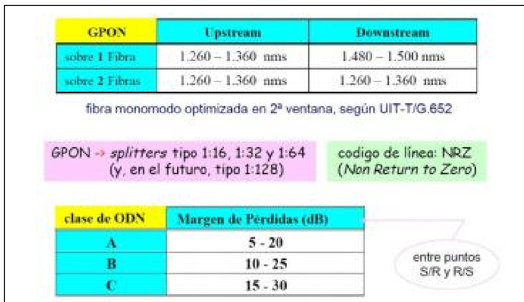
Figura 2.11 Capa Física GPON
