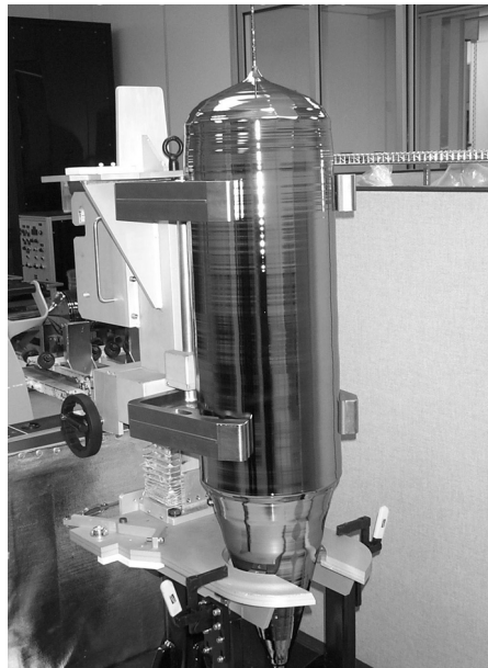
Figura 2.3 Lingote de silicio mono cristal a 300 mm en un dispositivo de manipulación de materiales 7
