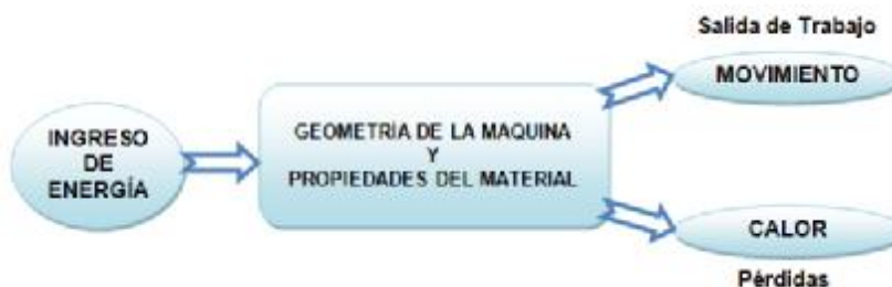
Figura 9.1 Funcionamiento de un micro-actuador
