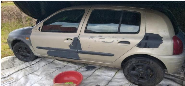
*Nota.* Proceso de lijado con grano 600 y acabado para el sistema bicapa.
