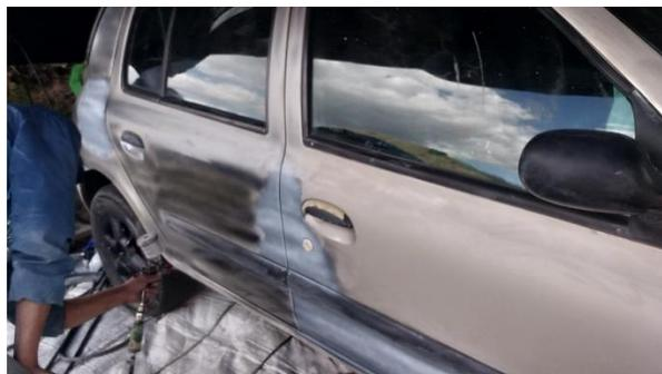
*Nota.* La aplicación del control de lijado es en toda la carrocería del vehículo y con ello identificaremos partes que aún falta lijar.
