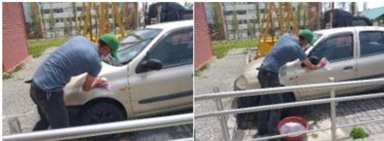
*Nota.* Limpieza de la carrocería con agua y detergente para la eliminación de polvo y otras sustancias.
