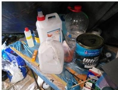
*Nota.* La mezcla del camaleón se realiza para un vehículo completo un litro de pintura con un litro de diluyente.
