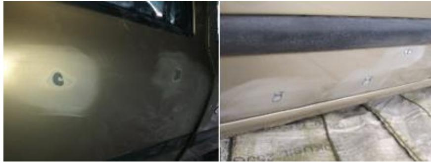
*Nota.* Leves golpes que se elimina con el lijado y una capa de masilla.
