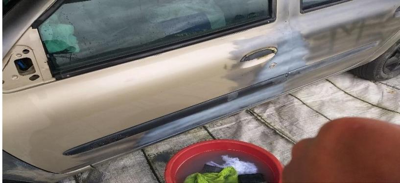
*Nota.* Proceso de lijado con grano 400 y eliminación del control de lijado.
