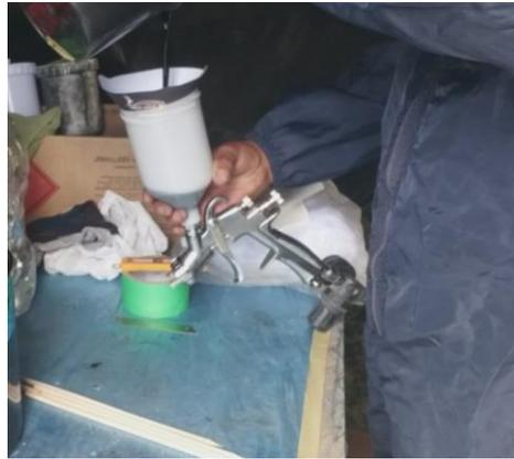
*Nota.* Este tipo de equipo trabaja con una presión de 2 a 3 bar con abanico a tope y 3 vueltas de regulación de pintura.
