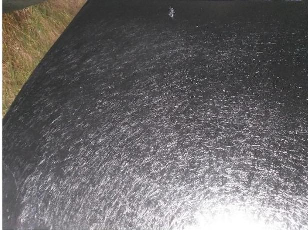
*Nota.* La aplicación de la base color negro sobre el cristalizado sirve para que se forme marcas del efecto de cristales en capa de camaleón.
