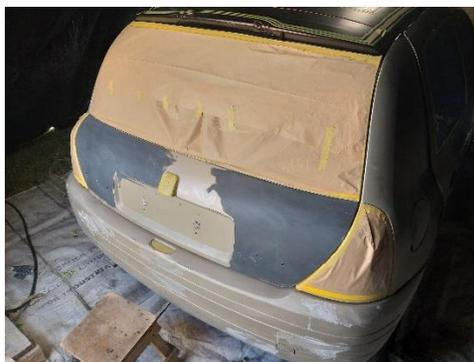
*Nota.* Las partes que no se pintara se debe de empapelar para evitar que se manchen y que tengan brisado de pintura y luego se nos haga difícil retirar.
