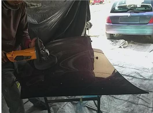
*Nota.* El abrillantado es mucho más rápido y con una franela se elimina el exceso de pulimento tras pasar la máquina y evitar que se quede endurecido o quemado la pintura.
