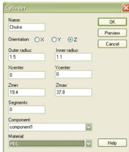
Figura. 3.32 Cuadro de diálogo de configuración del choke.
