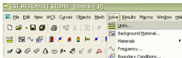
En el cuadro de diálogo se configuran las unidades, así las dimensiones de la antena estarán dadas en mm, la frecuencia en GHz y el tiempo en ns.
