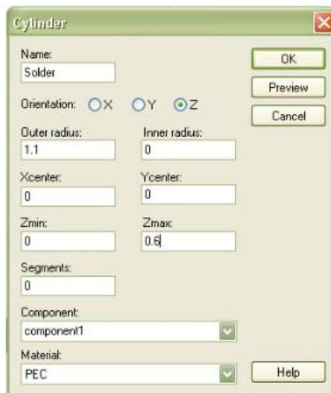
Figura. 3.24 Cuadro de diálogo de configuración de la soldadura
