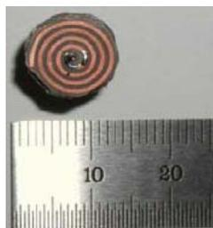
**Figura. 1.5. Pequeña antena en forma espiral para la cápsula endoscopio [7]**
