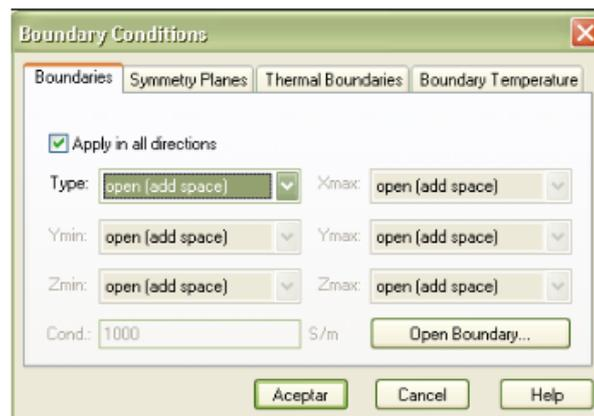
Figura. 3.52 Cuadro de configuración de las condiciones de borde, boundaries.
