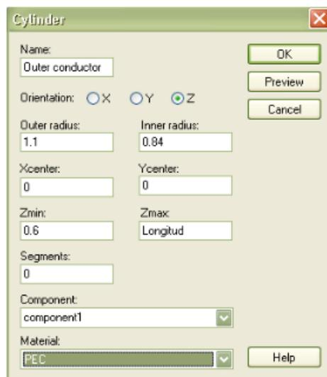
Figura. 3.22 Cuadro de diálogo de configuración del conductor externo
