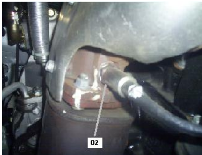
Figura 2.11. Ubicación del Sensor de oxígeno
