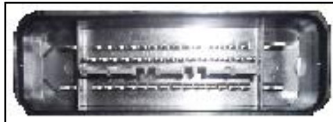
Figura 3.6 Identificación de los Bornes del Enchufe del Módulo de Control del ABS.
