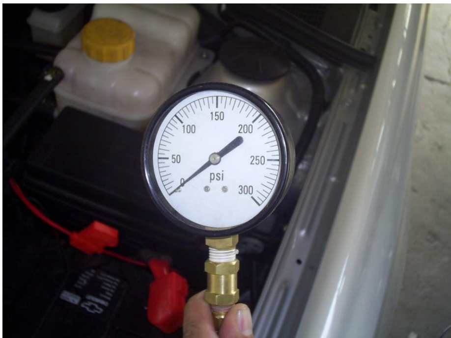
Figura 4.28. Manómetro de presión de fluido hidráulico.
