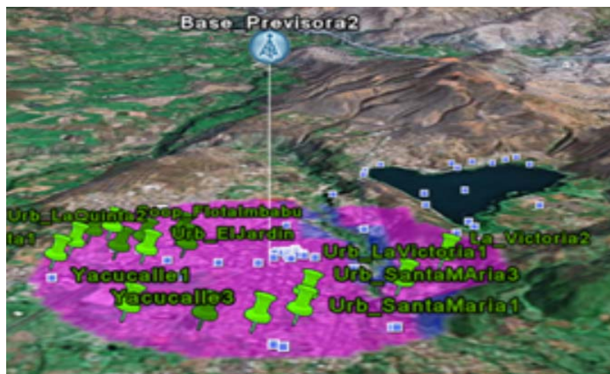
Figura.5.33. Resultados de cobertura para radio 2Km desde el AP (Google Earth) en 3D
